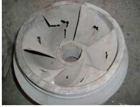
ΣΧ. 26 διάβρωση στροφείου φυγοκεντρικής αντλίας λόγω σπηλαιώσης.
