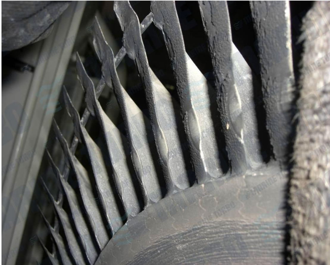
Εικόνα 3.1.3: Φθορά πτερυγίων στοβίλου λόγο κραδασμών.
