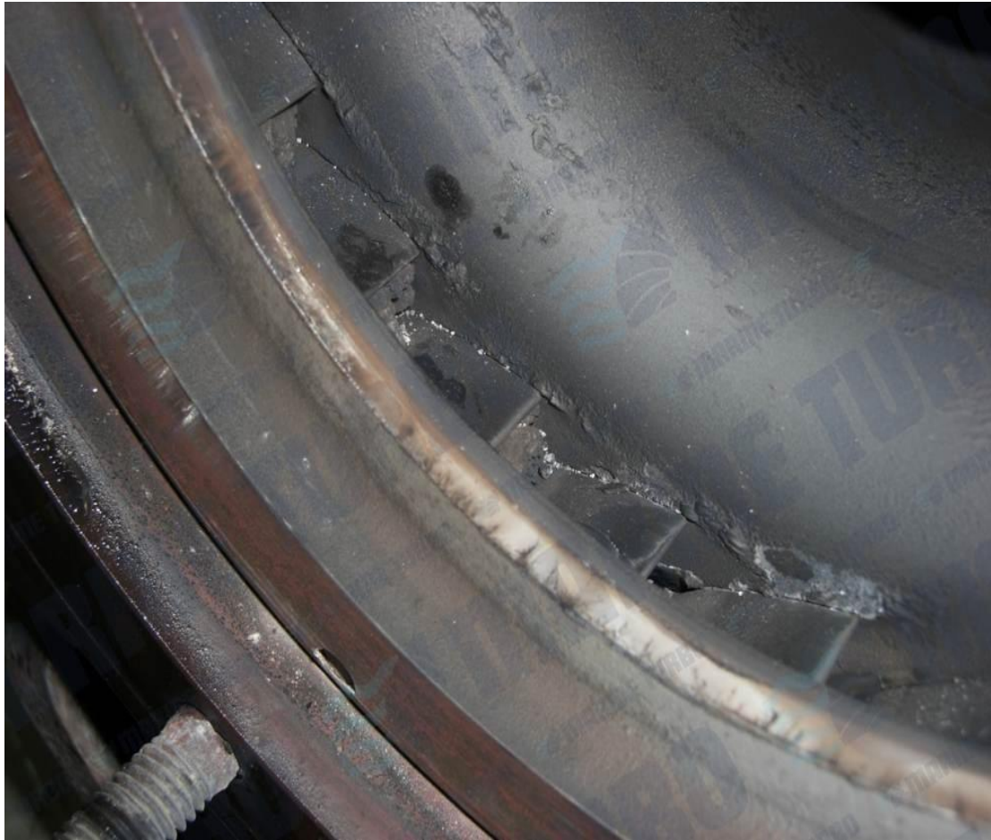
Εικόνα 3.1.2: Η ατελής καύση του καυσίμου δημιούργησε εξανθρακώματα τα οποία πέρασαν και προσκολήθηκαν στο κέλυφος του στροβίλου.
