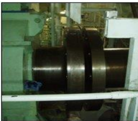
Σχ. 11. Διάφορες περιπτώσεις διάταξης κατά τη διαδικασία sag and gap
