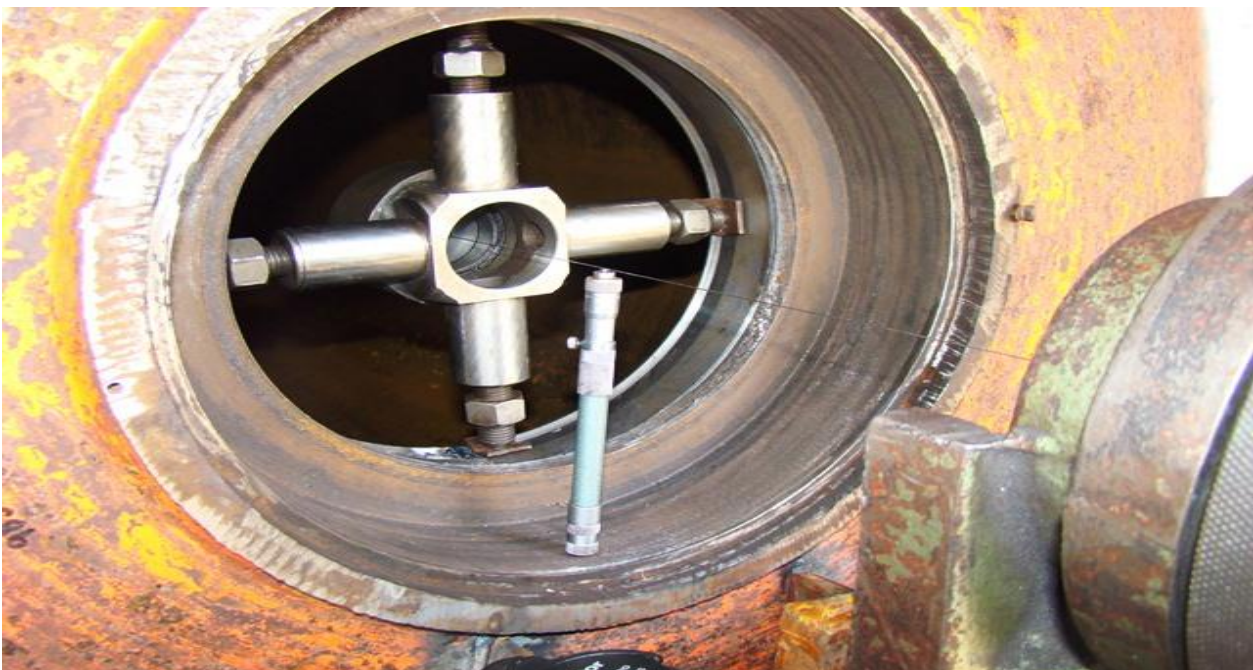
Σχ. 7. Ευθυγράμμιση αξονικού συστήματος. Ορισμός γραμμής αναφοράς
