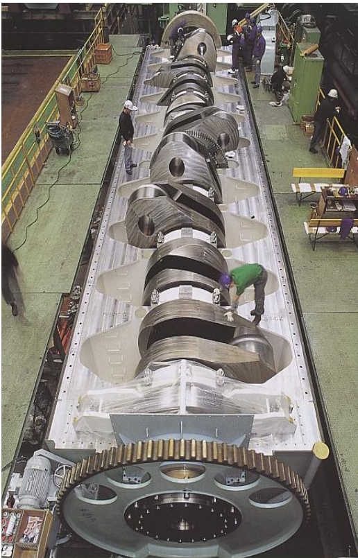
Σχ. 3. Έδραση στροφαλοφόρου άξονα
