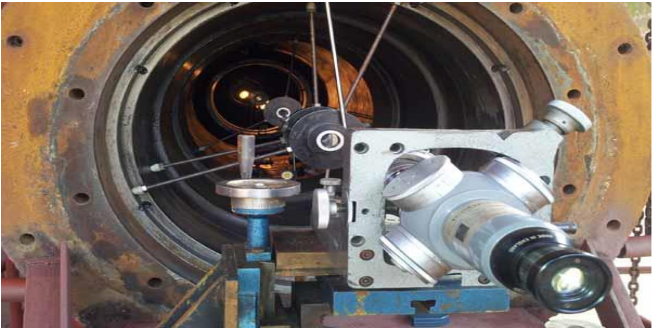
Σχ. 8. Τεχνικές τεντωμένου σύρματος και οπτικών συστημάτων ή συστημάτων Laser
