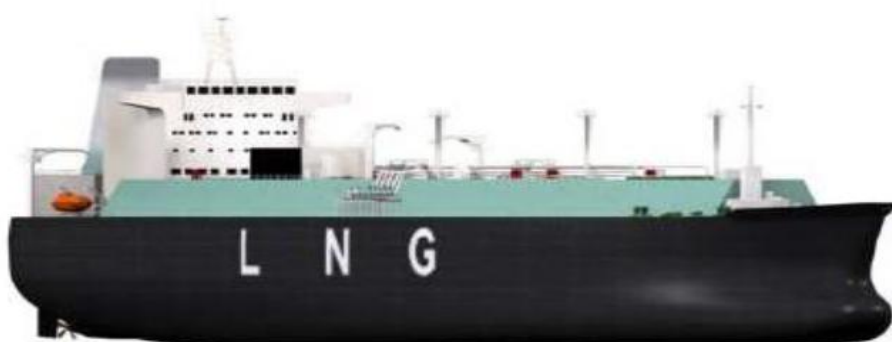
Εικόνα 17. Πλοίο μεταφοράς LNG μεμβράνη μεταφοράς υγραερίου.
