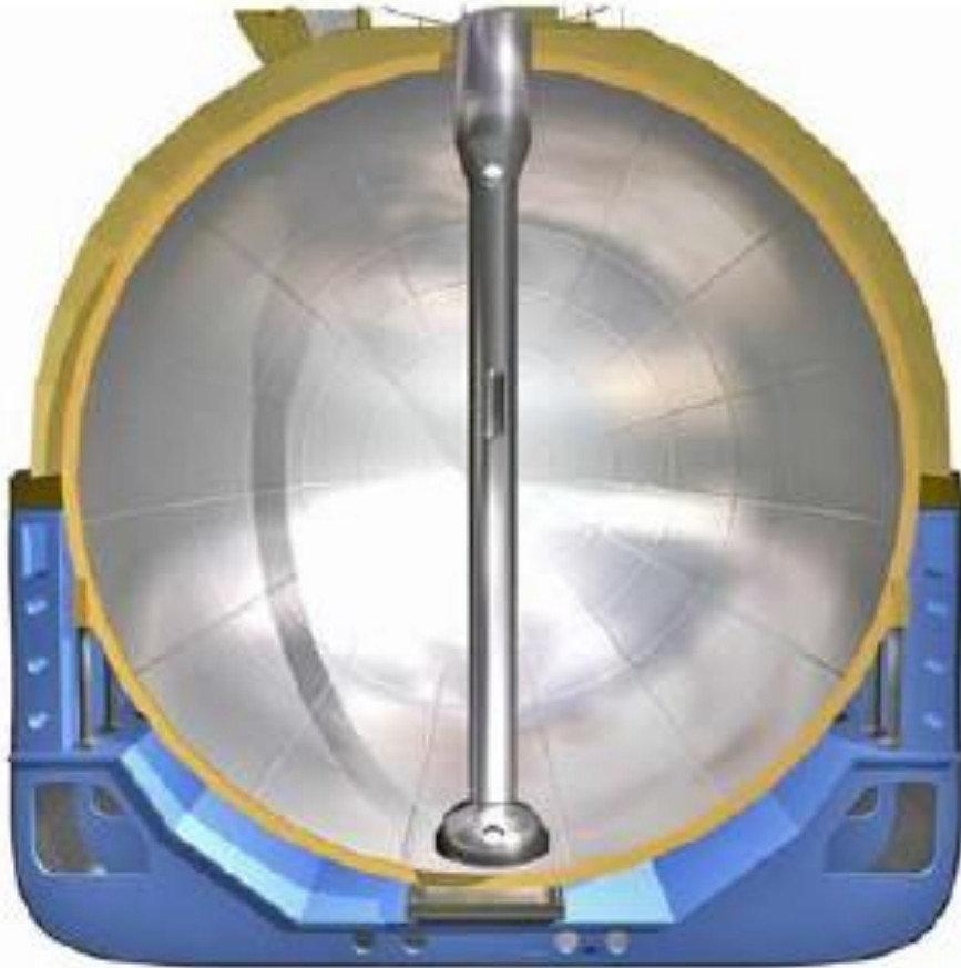
Εικόνα 10. Εσωτερικό δεξαμενής LNG.
