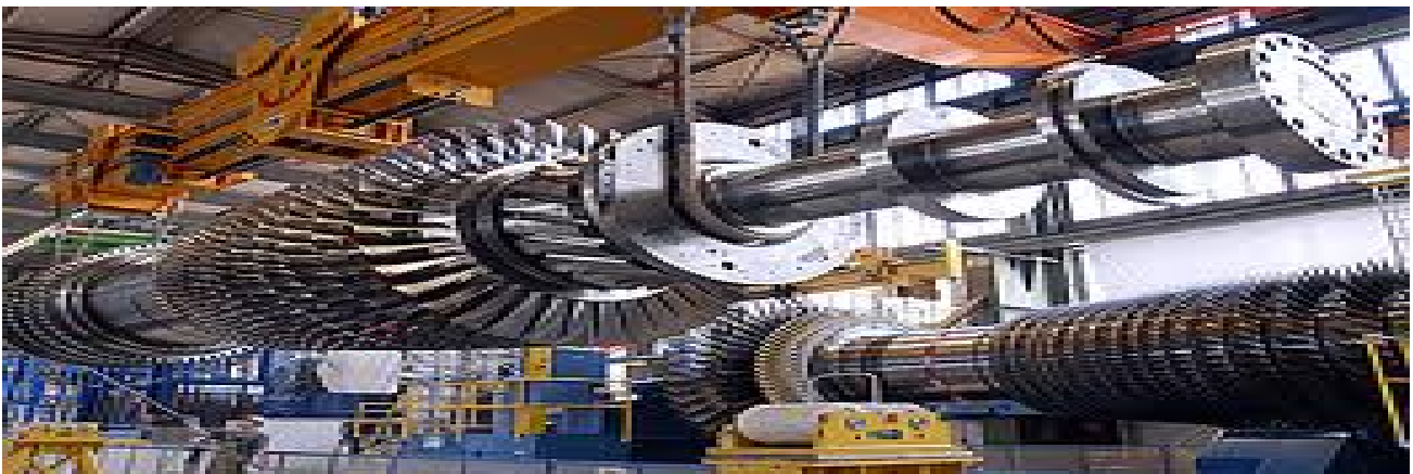
Εικόνα 4.6.2. Πλήρης διάταξη των περυγίων του αεροστροβίλου.
