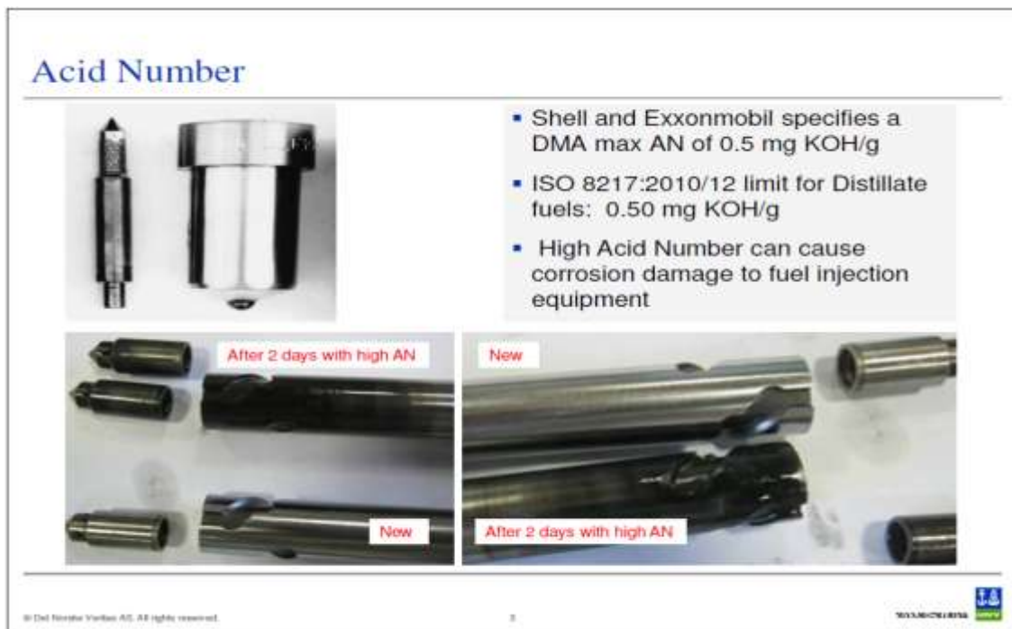
Σχ 8. Επίδραση της οξύτητας στο σύστημα ψεκασμού (Πηγή:DNVPS)
