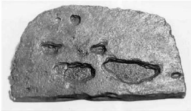
Σχ 10. Διάβρωση (pitting) πυθμένα χαλύβδινης δεξαμενής καυσίμου οφειλόμενη σε SRB (Πηγή: ECHA Microbiology Ltd.)
