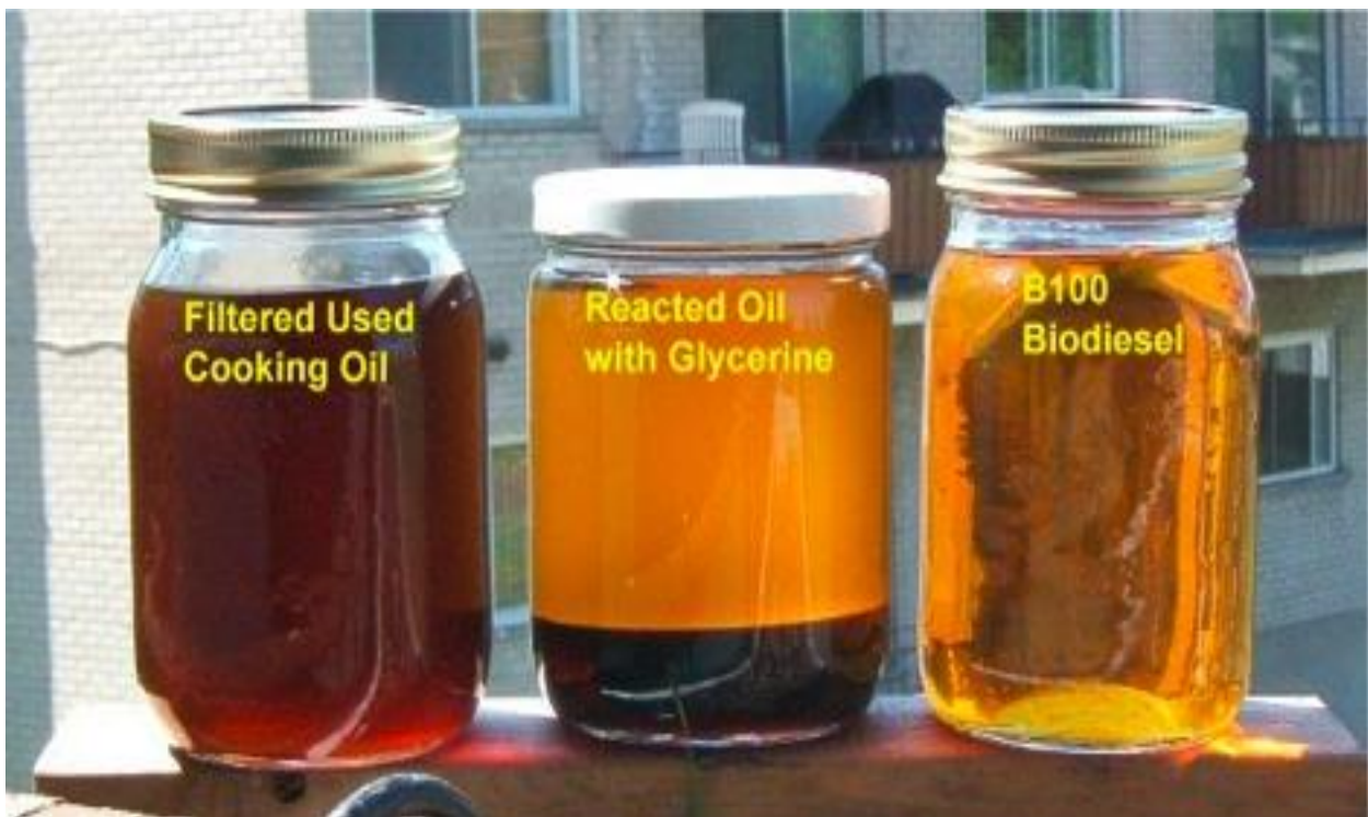
Εικόνα 7.1: Μορφή ελαίου κατά την ανάμιξη με γλυκερίνη για τη δημιουργία βιοντίζελ.
