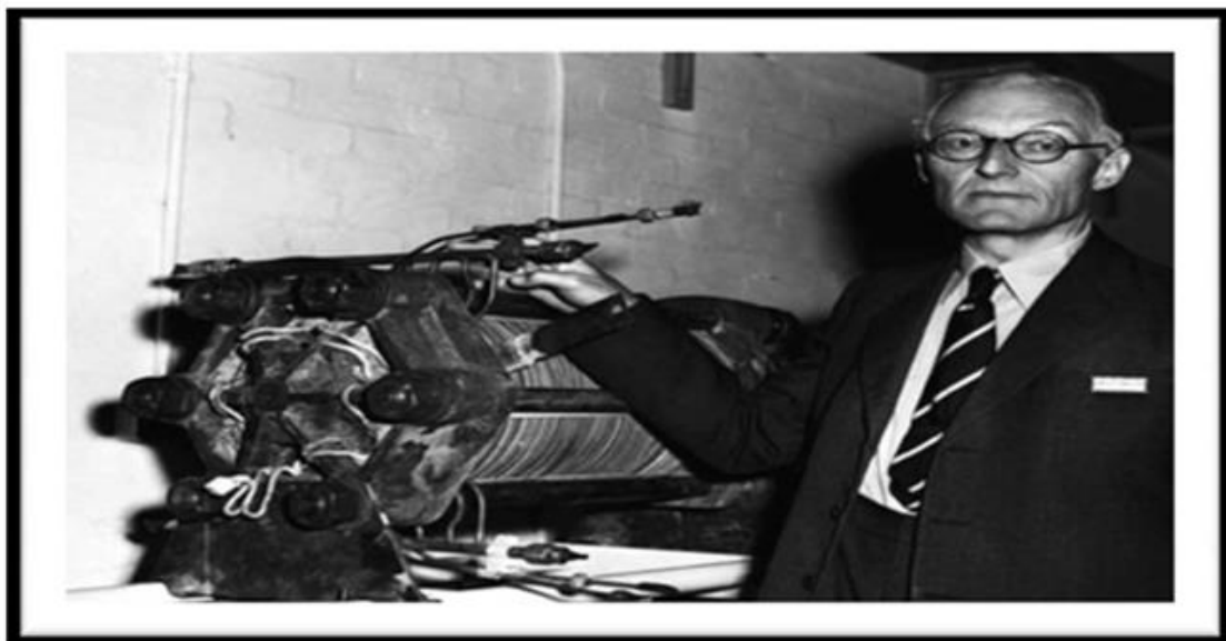
Σχήμα 1.1 Ο Bacon με την κυψέλη καυσίμου των 6KW
