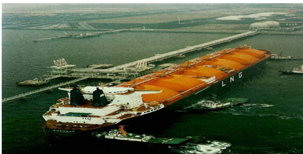
Εικόνα Νο.4 – Φωτογραφία Πλοίου Τύπου LNG με Κυκλική Δεξαμενή
