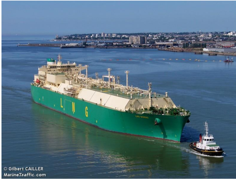
Εικόνα Νο.2 – Φωτογραφία Πλοίου Τύπου LNG με Ορθογώνια Τραπεζοειδής Δεξαμενή
