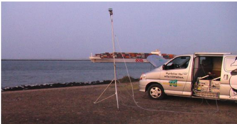
Σχ. 12 Επίγεια πλατφόρμα για ανίχνευση και ανάλυση ρύπων πλοίων. Διακρίνεται ο αισθητήρας (sniffer), ανεμόμετρο και οι συσκευές ανάλυσης στο όχημα. (Chalmers University of Technology)
