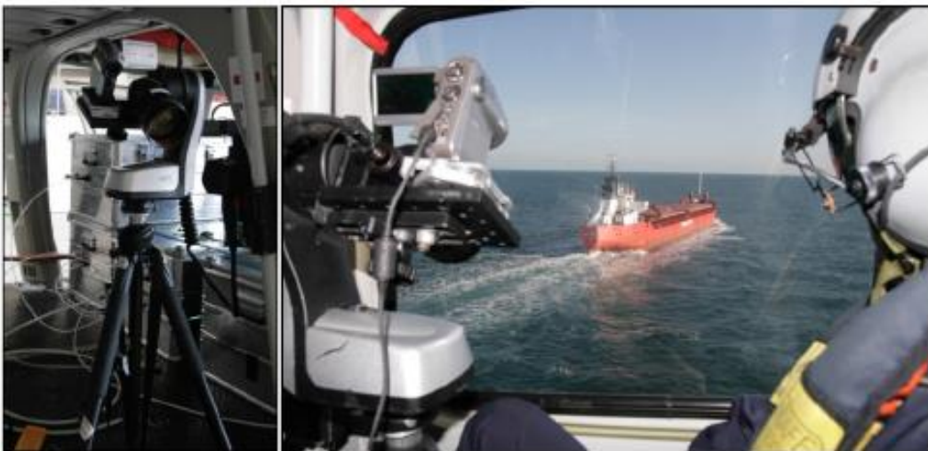
Σχ. 9 Μετρήσεις ρύπων με την οπτική μέθοδο (αξιολόγηση μεθόδου) (Chalmers University of Technology)
