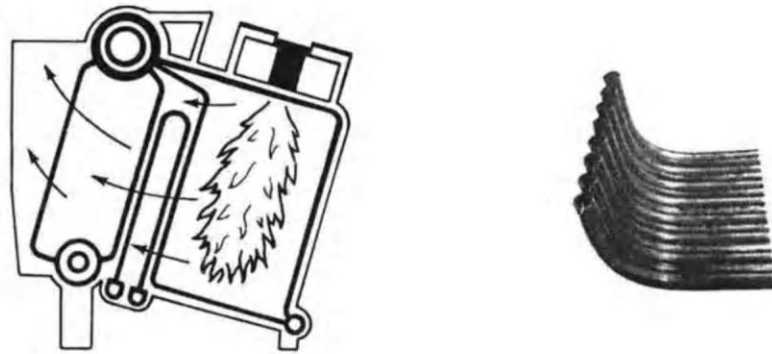
Σχήμα 4.3 Γενική διάταξη λέβητα και τοιχώματα αυλών.
