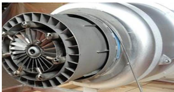
Εικόνα 4: Καυστήρας φυσικού αερίου
