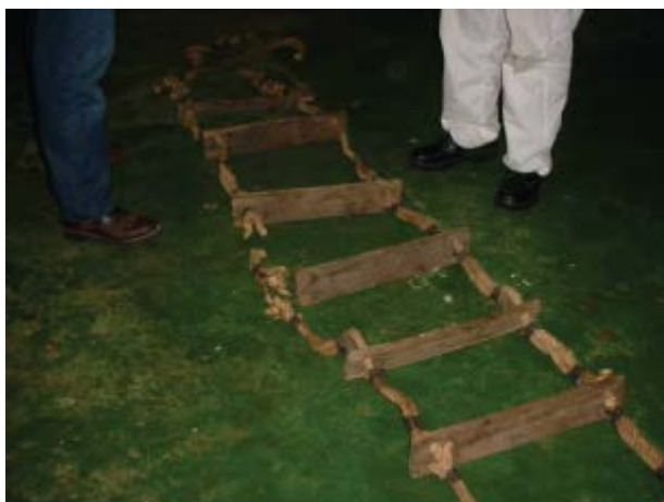
Εικ.1-2: Σπασμένη σκάλα σε 6 σημεία Περίπου 3 m.
