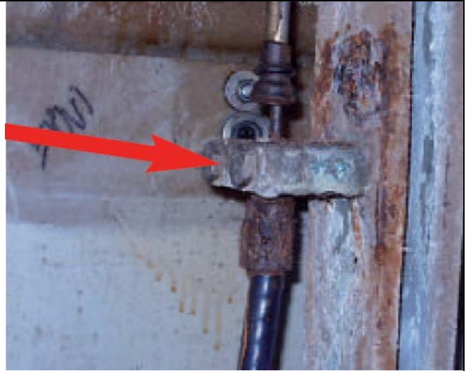
Εικόνα1-9:Μια πιο προσεκτική ματιά στο καλώδιο πρυμναίου αριστερού άγκιστρου, προτασία καλωδίου σκουριασμένη και σπασμένη
