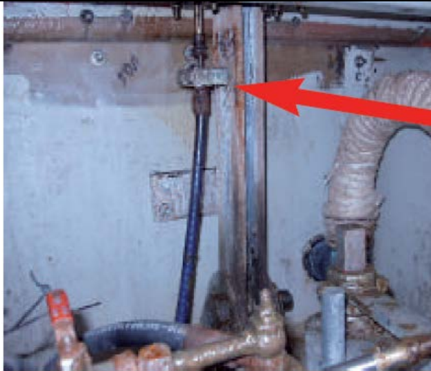
Εικόνα1-8:Συρματόσχοινο Άγκιστρον, αριστερή σωσίβια λέμβος (Συρματόσχοινο πρυμναίου άγκιστρου).
