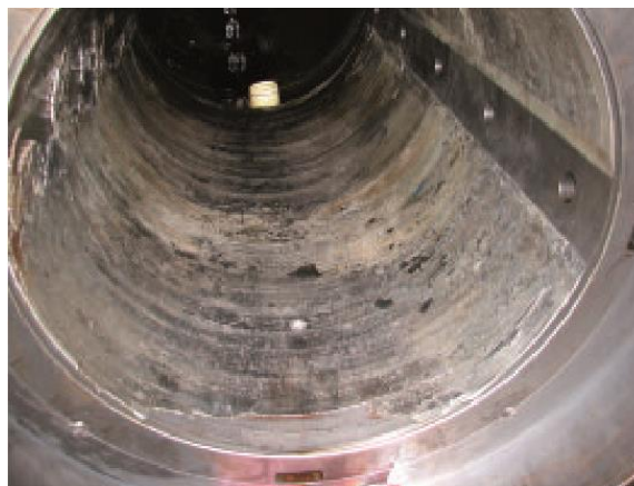
Εικ.2.6.2: Κατάσταση λευκού μετάλλου του εδράνου όταν βρέθηκε.
