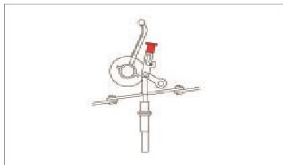
Εικ 1.3.2: Απεικόνιση υδροστατικής απελευθέρωσης όταν είναι ασφαλισμένη στην ανοικτή θέση. Αν το χερούλι μετακινηθεί καταλάθος η σωσίβια λέμβος θα ελευθερωθεί.
