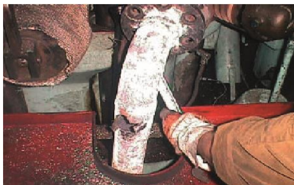
Εικ.2.5.1: Σκασμένος σωλήνας αέρα λόγω
