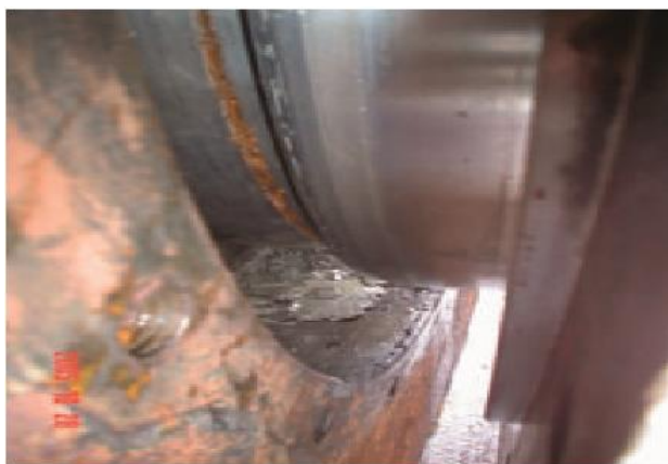
Εικ.2.6.1: Κομμάτια λευκού μετάλλου που βρέθηκαν στο πίσω έδρανο μετά από την αφαίρεση της ασφάλειας.
