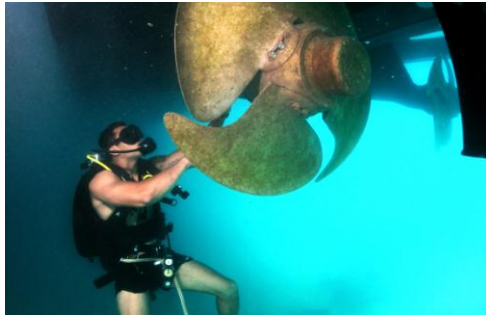
Εικόνα: Επιθεώρηση έλικας από δύτη.
