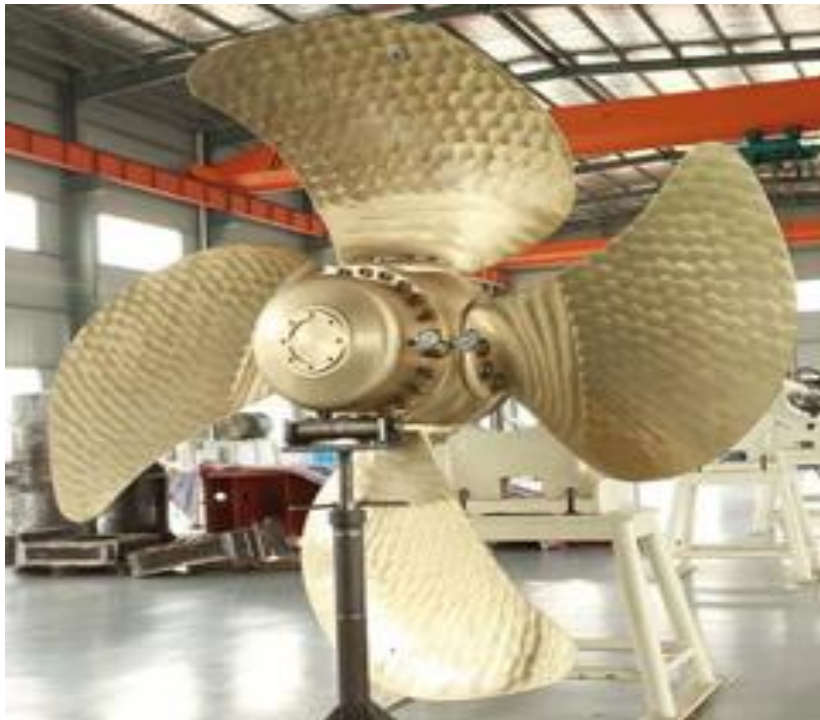
Εικόνα: έλικα μεταβλητού βήματος.
