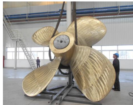
Εικόνες: έλικες σταθερού βήματος
