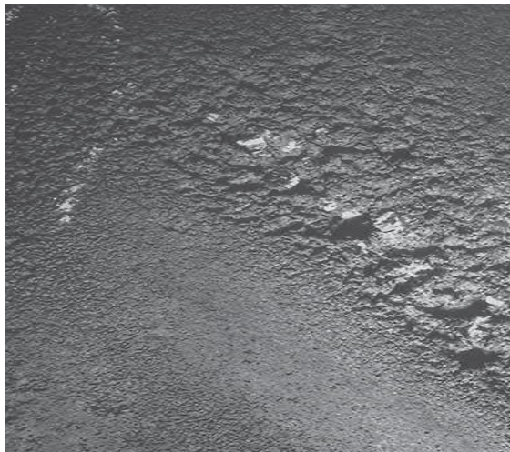
Εικόνα. Τυπική περίπτωση σπηλαιώσης σε έλικα
