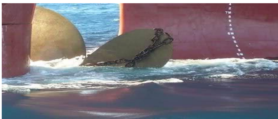
Εικόνες. Βλάβη έλικας λόγω επαφής με αλυσίδες πρόσδεσης.
