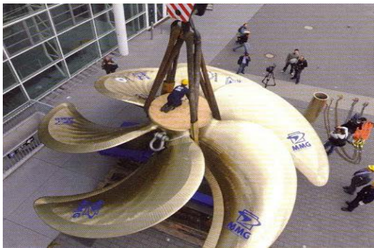
Εικόνες: έλικες σταθερού βήματος
