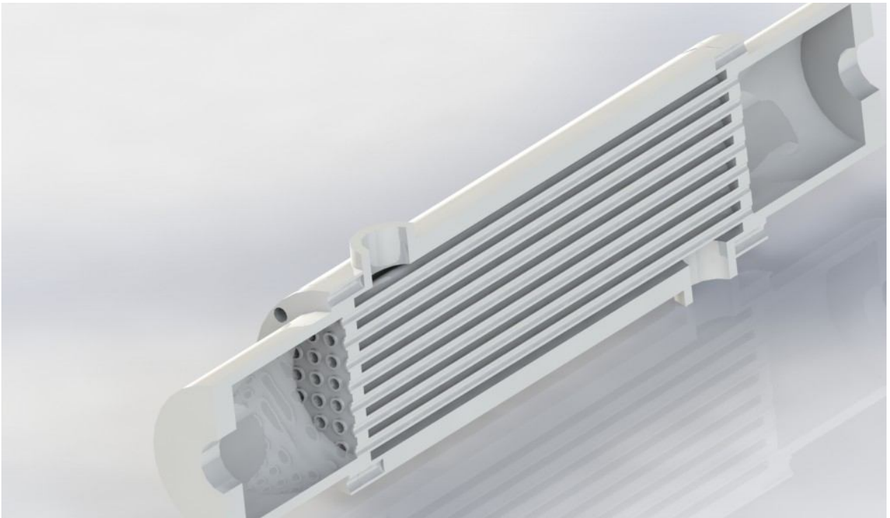
Εικόνα 5.35: Φωτορεαλιστική απεικόνιση συμπυκνωτή σε τομή
