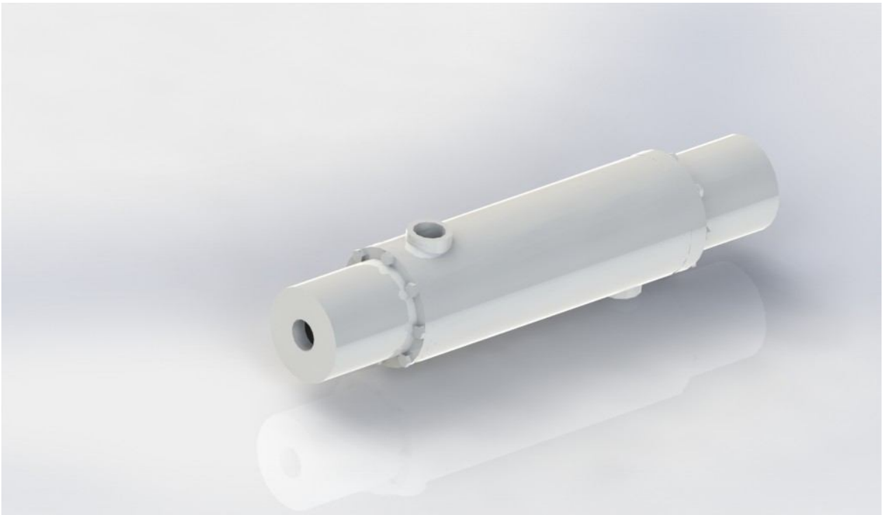
Εικόνα 5.13: Φωτορεαλιστική απεικόνιση συμπυκνωτή ψυκτικής εγκατάστασης
