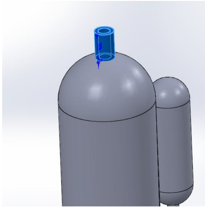
Εικόνα Π.62: Δημιουργία τρισδιάστατου σωλήνα στο χώρο με τη βοήθεια της εντολής εξώθησης
