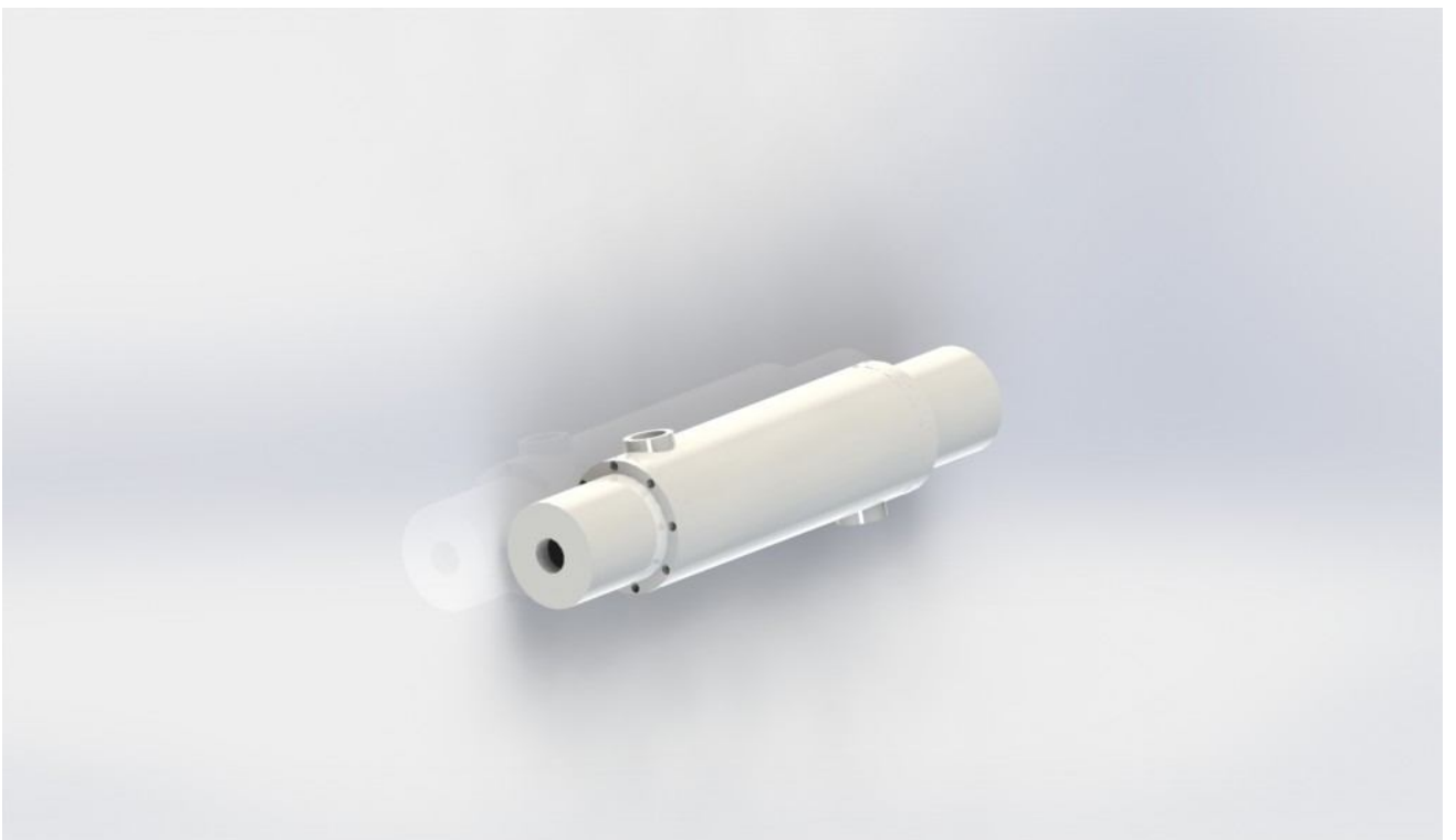
Εικόνα 5.12: Φωτορεαλιστική απεικόνιση σύνδεσης αυλών, αυλοφόρων πλακών, σώμα συμπυκνωτή και πομάτων
