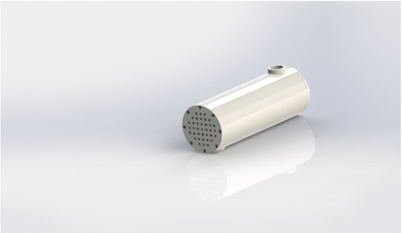
Εικόνα 5.11: Φωτορεαλιστική απεικόνιση σύνδεσης των αυλών με τις αυλοφόρες πλάκες και το σώμα συμπυκνωτή
