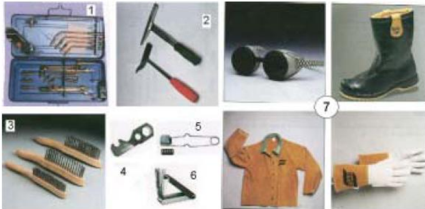
Σχήμα (5.12): Ο εξοπλισμός του οξυγονοκολλητή: (1) Μεταλλική θήκη με τα απαραίτητα εξαρτήματα οξυγονοκόλλησης και οξυγονοκοπής (2) Ειδικά σφυριά οξυγονοκολλητή (3) Συρματόβουρτσες (4) Ειδικό κλειδί συσκευών O-A (5) Αναπτήρας οξυγονοκολλητή (6) Σειτ συρμάτων καθαρισμού των ακροφυσίων (7) Μέσα προστασίας: γυαλιά, μπότες, δερμάτινο σακάκι και γάντια
