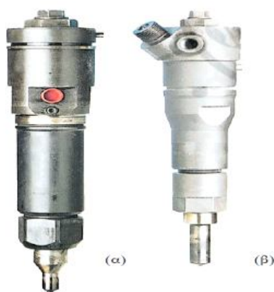
Σχ. 1.3: Εγχυτήρες καυσίμου σε τετράχρονη πετρελαιομηχανή [(α) κύριος, (β) πιλοτικός]. Οι φωτογραφίες τους δεν είναι στην ίδια κλίμακα
