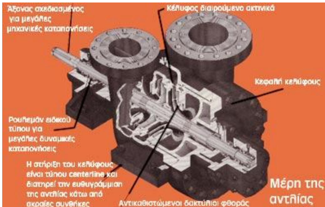
Εικόνα 5: Τομή φυγοκεντρικής αντλίας
