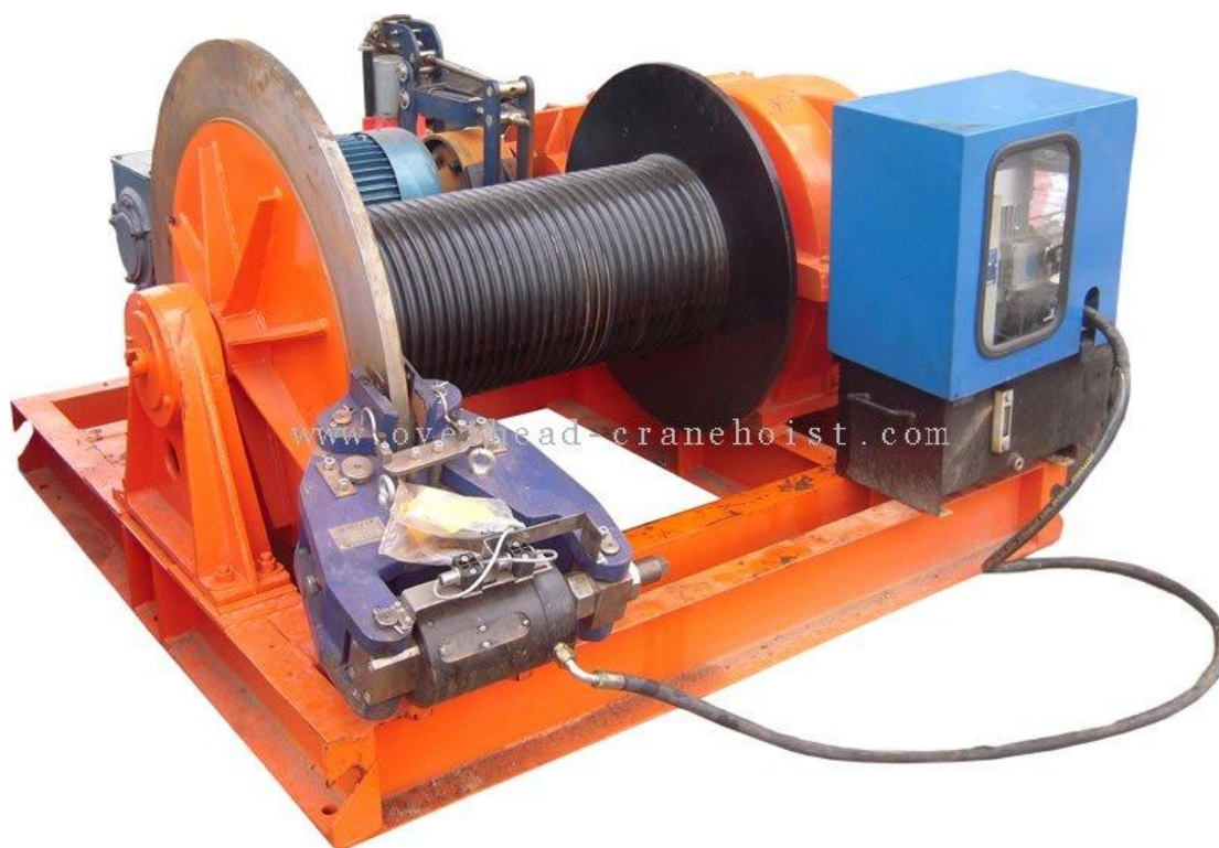
Εικόνα 1.1 : Ηλεκτρικό βαρούλκο αποτελούμενο από οριζόντιο κύλινδρο
