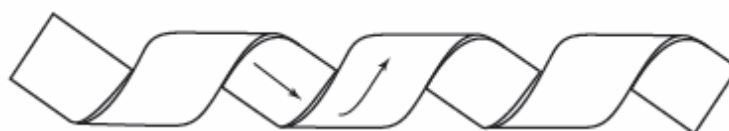
Εικόνα 3.2 Διαμόρφωση ελάσματος για σωλήνα ελικοειδούς ραφής
