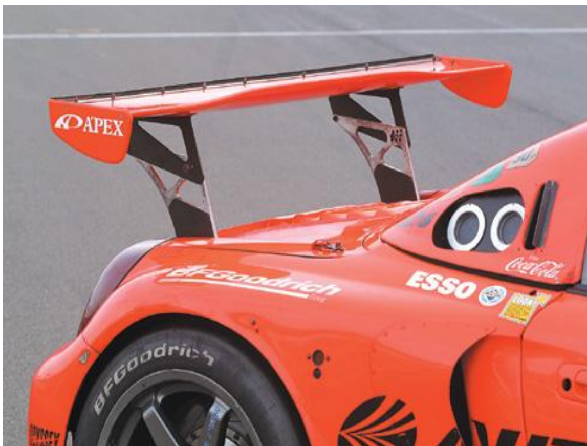
Εικόνα 1.1: Αεροτομή σε αγωνιστικό Toyota MR-S για αύξηση της κάθετης δύναμης
