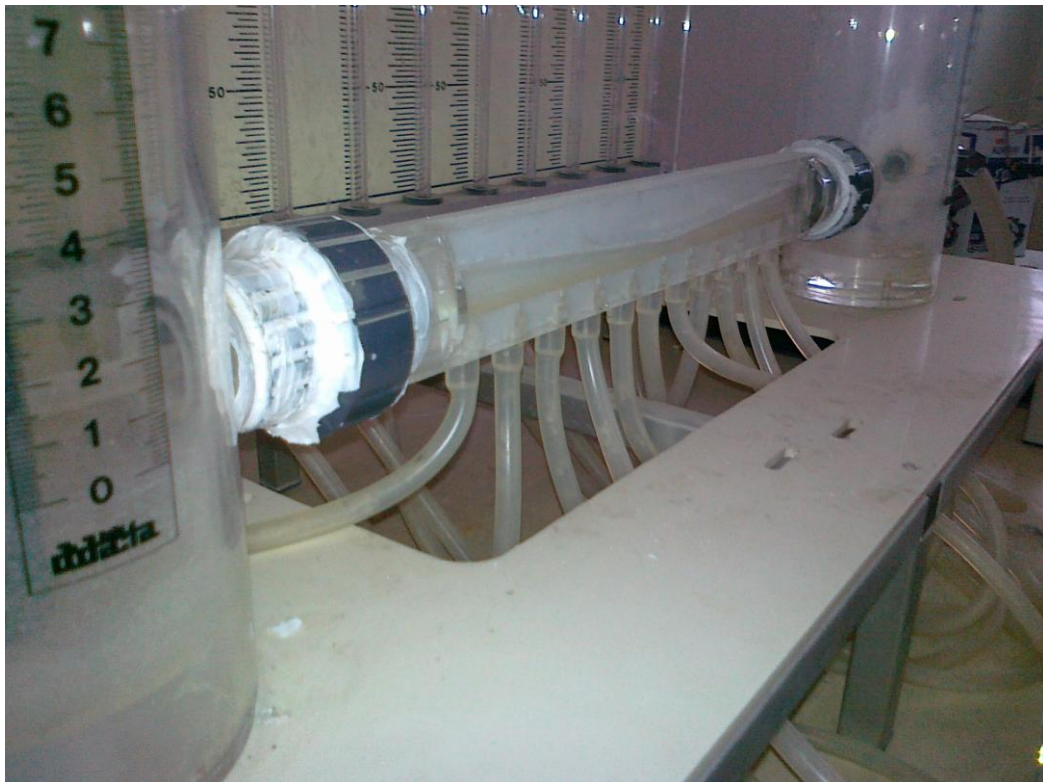
Εικόνα 3.1 Plexiglas επισκευασμένο με σιλικόνη
