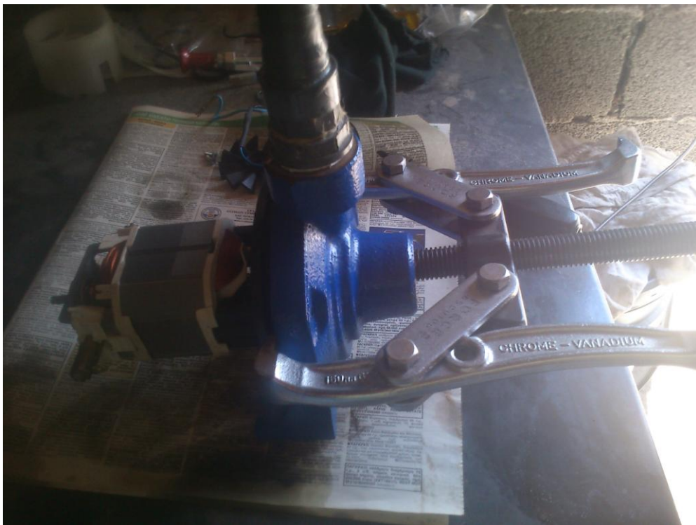
Εικόνα 3.7 Εξάρμωση του κέλυφους της αντλίας
