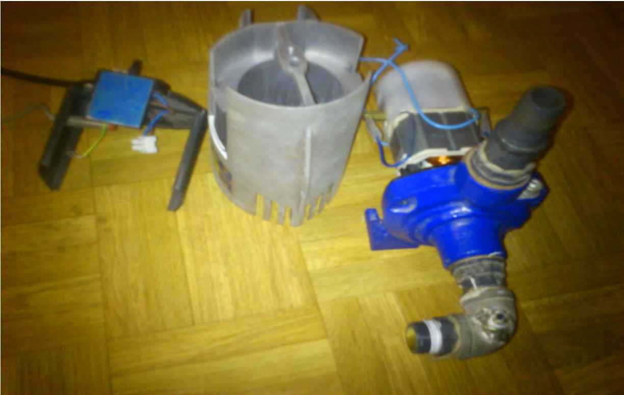
Εικόνα 3.5 Η αντλία με το κέλυφος του ηλεκτρικού μοτέρ εξαρμωμένο
