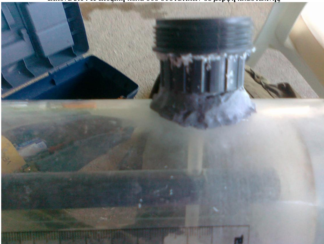
Εικόνα 3.15 Επισκευασμένο το Plexiglas δοχείο με την εποξική κόλα δυο συστατικών
