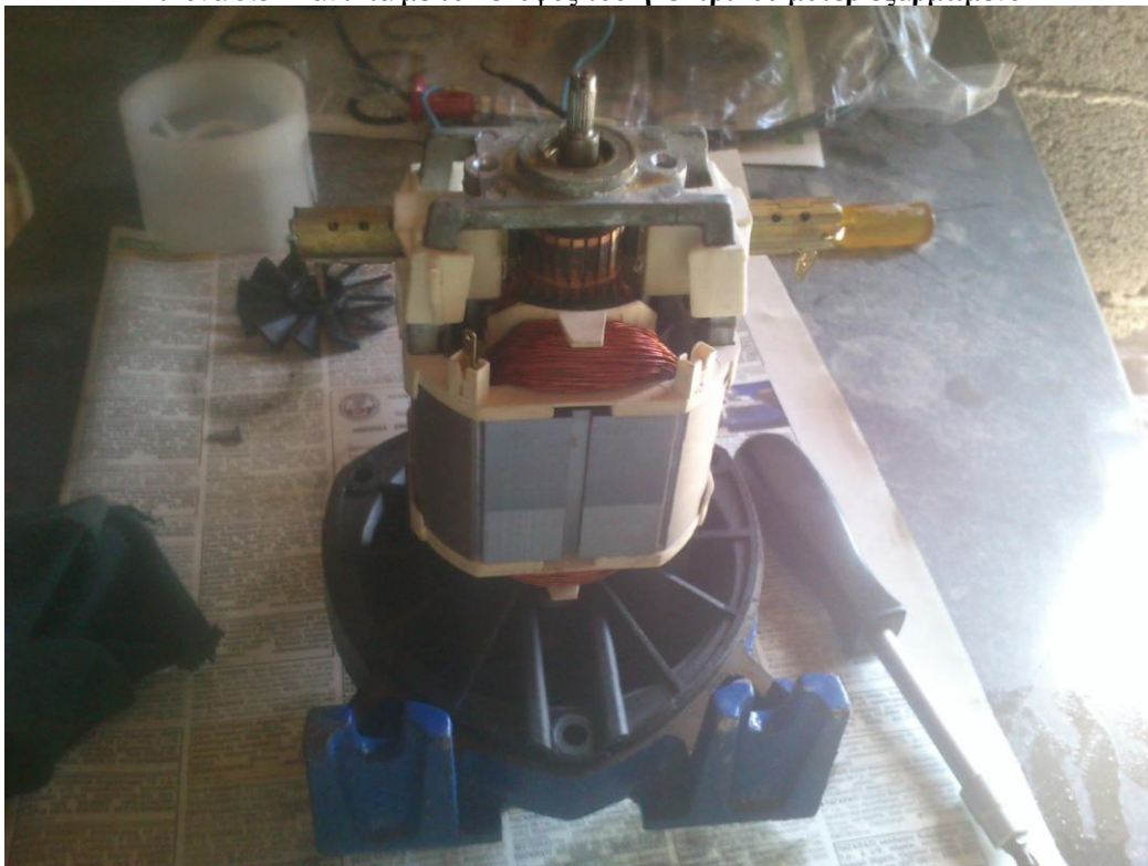
Εικόνα 3.6 Το ηλεκτρικό μοτέρ της αντλίας δίχως τον ανεμιστήρα
