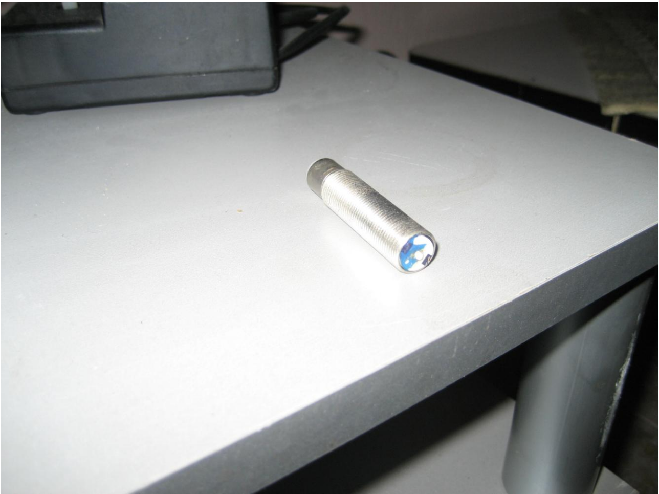
Εικόνα 3.13 Το pickur στροφών της αντλίας
