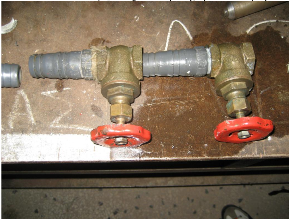
Εικόνα3.18 Οι δυο από τις τρεις βάνες επισκευασμένες
