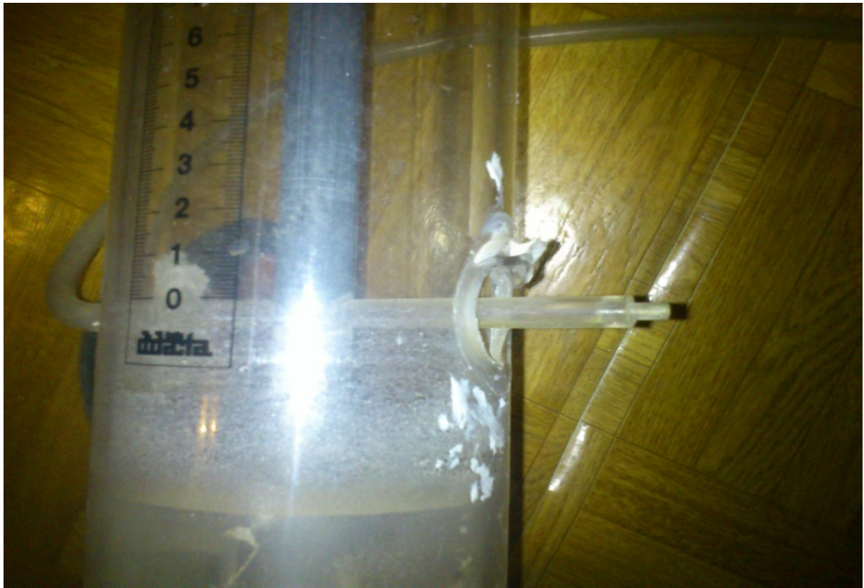
Εικόνα 3.4 Το Plexiglas του μετρητικού δοχείου σπασμένο
