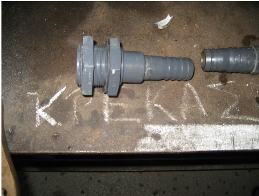
Εικόνα 3.21 Ο σύνδεσμος του δοχείου αποθήκευσης νερού επισκευασμένη
