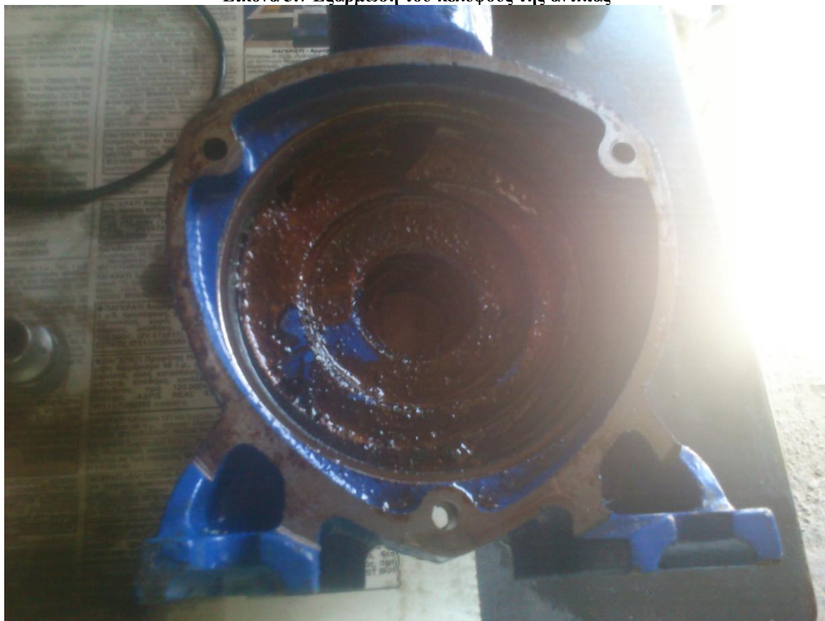
Εικόνα 3.8 Το κέλυφος της αντλίας εσωτερικά
