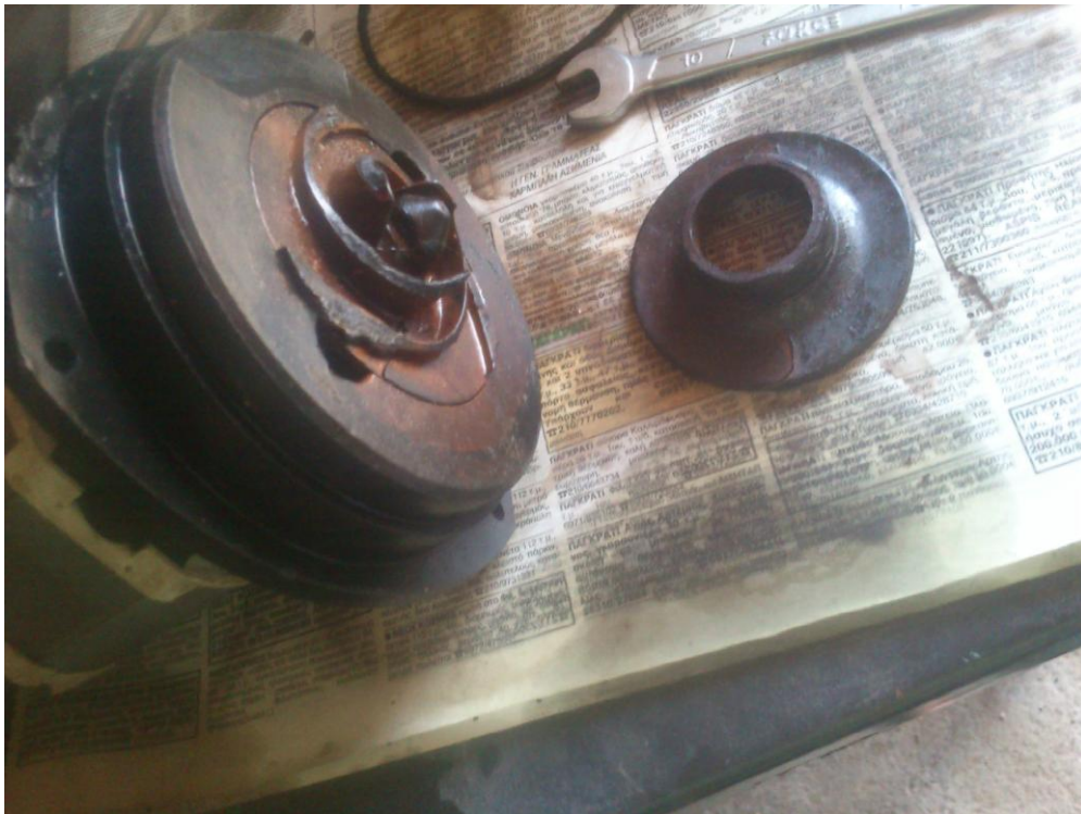
Εικόνα 3.9 Το εσωτερικό της αντλίας με το σπασμένο impeller
