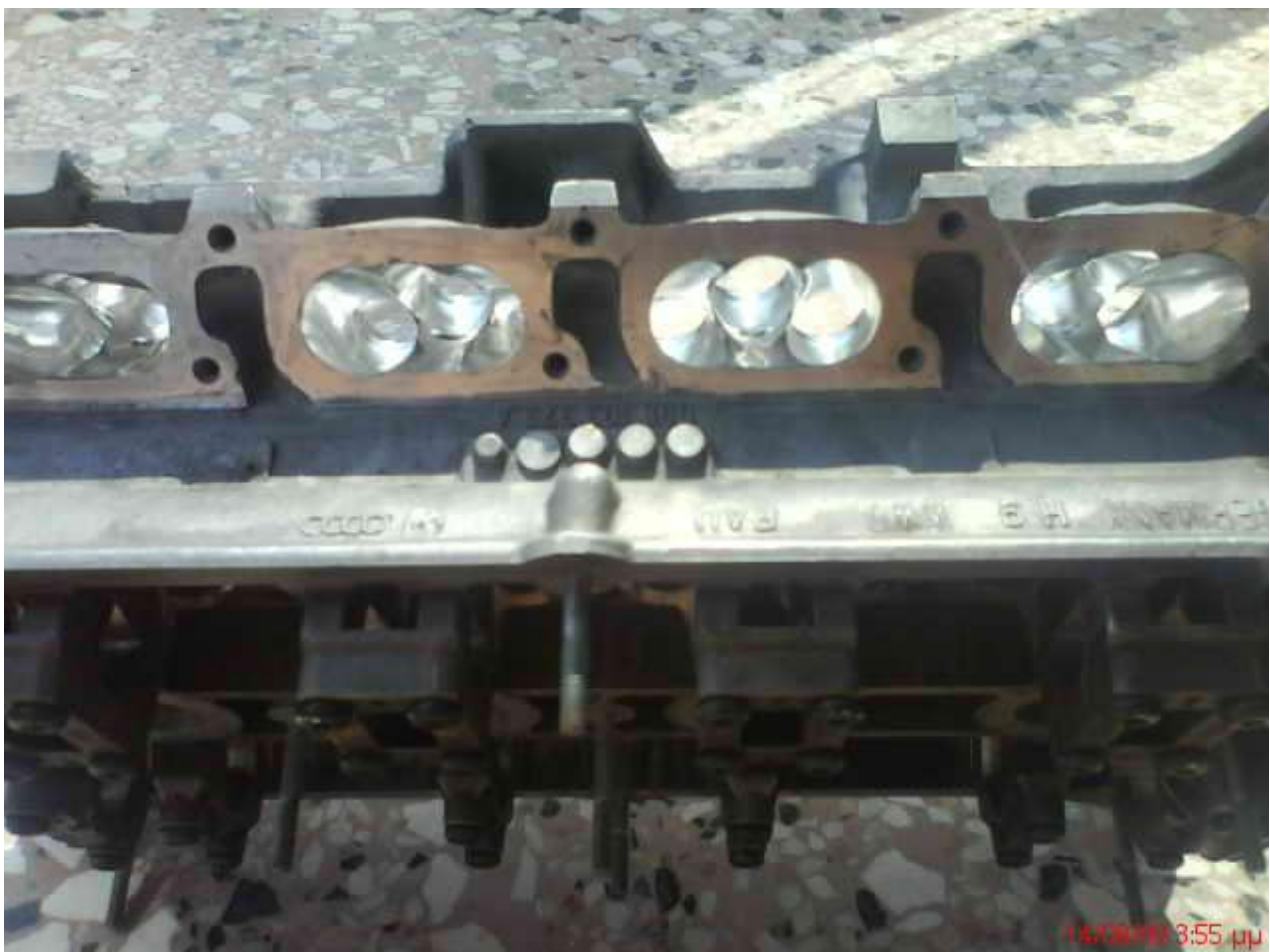
Εικόνα 1.3: Ροηκή εξέλιξη σε κυλινδροκεφαλή αυτοκινήτου
