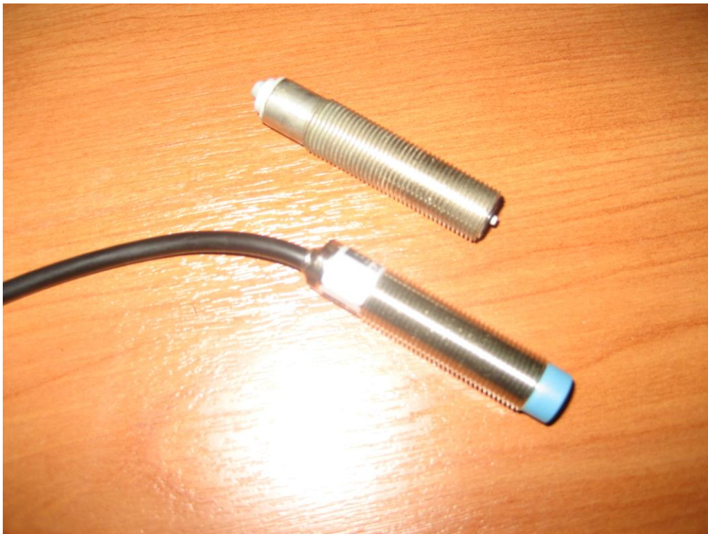
Εικόνα 3.16 Το παλιό και το νέο pickur
