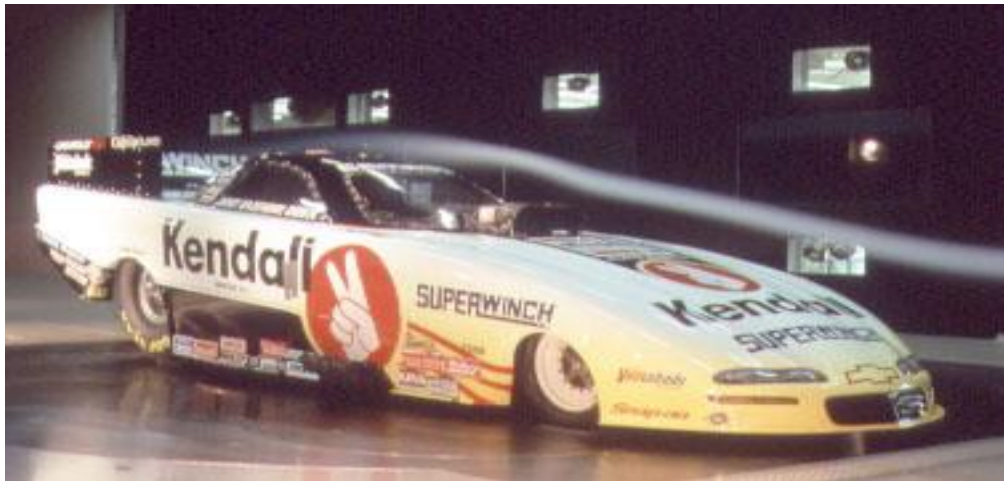
Εικόνα 1.2: Αγωνιστικό για αγώνες Dragster σε αεροδυναμική σήραγγα για καθορισμό της οπισθέλκουσας
