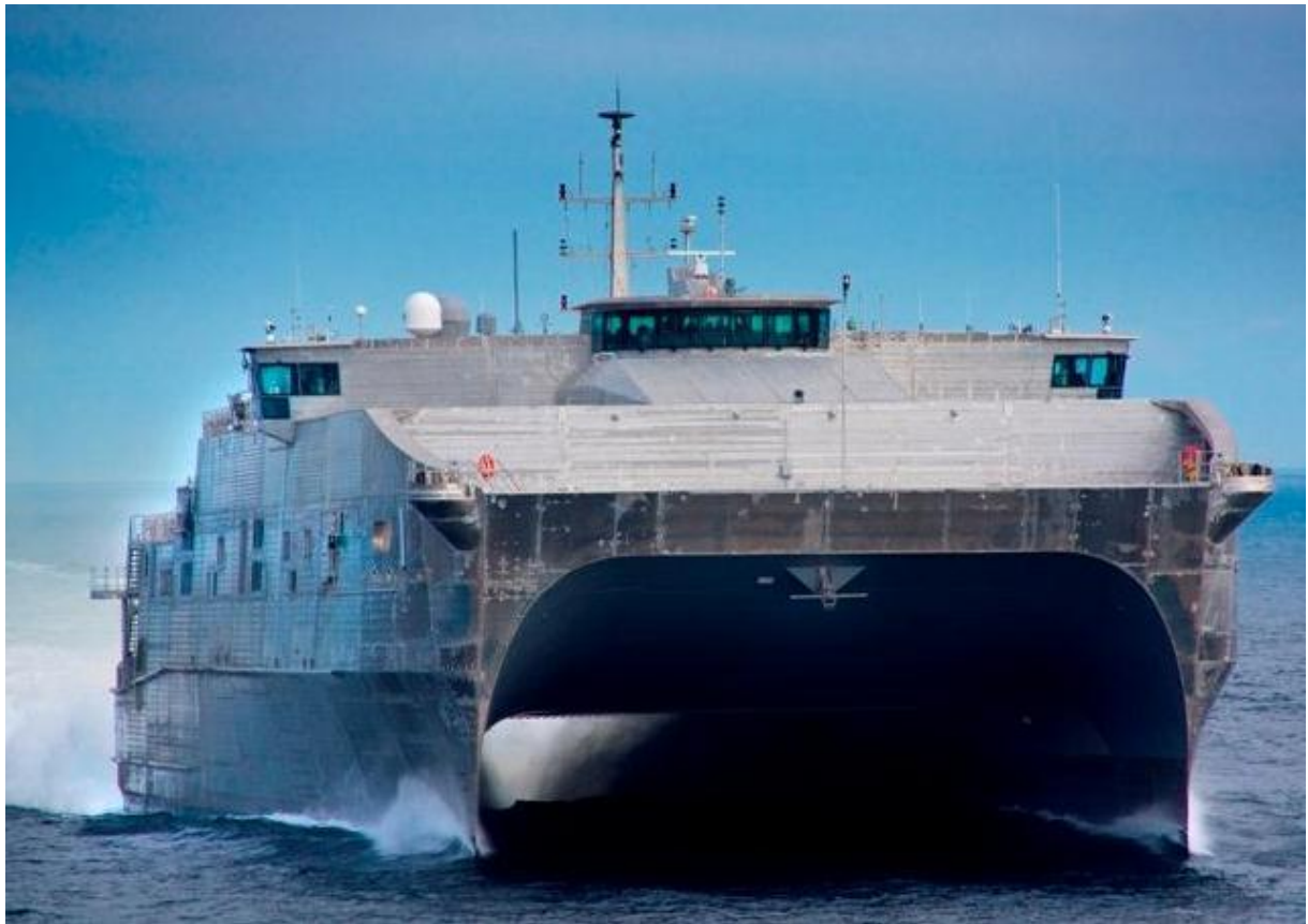
Εικόνα 10: Το JHSV 1, είναι ταχύπλοο catamaran με ιδιαίτερα αεροδυναμικό σχήμα
