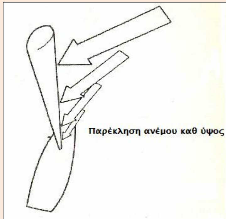
Εικόνα 3.20. Παρέκκληση ανέμου καθ' ύψος πανιού [Πηγή: Γεωργίου (2015)].
