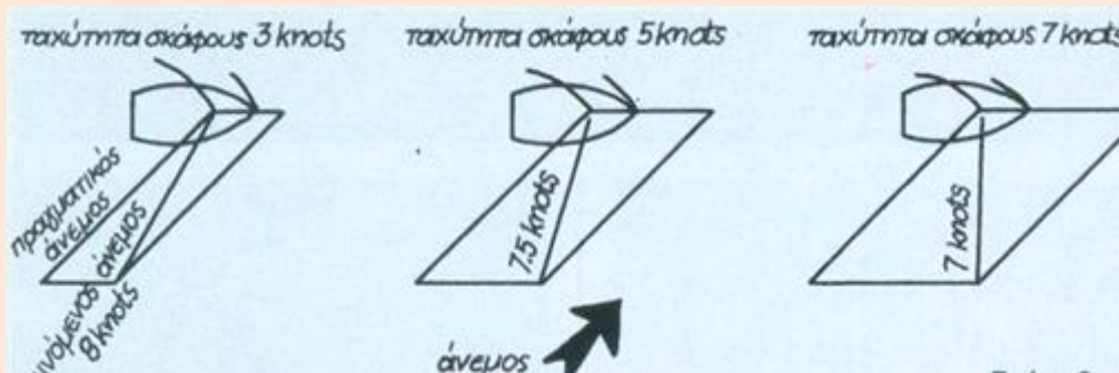
Εικόνα 3.22. Μεταβολή φαινομένου ανέμου σε σχέση με την ταχύτητα [Πηγή: Θαλασσινός (α) 2008)].
