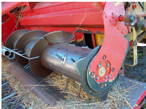
Εικόνα 2.1.1: ο κοχλίας του Αρχιμήδη σε θεριζοαλωνιστική μηχανή
