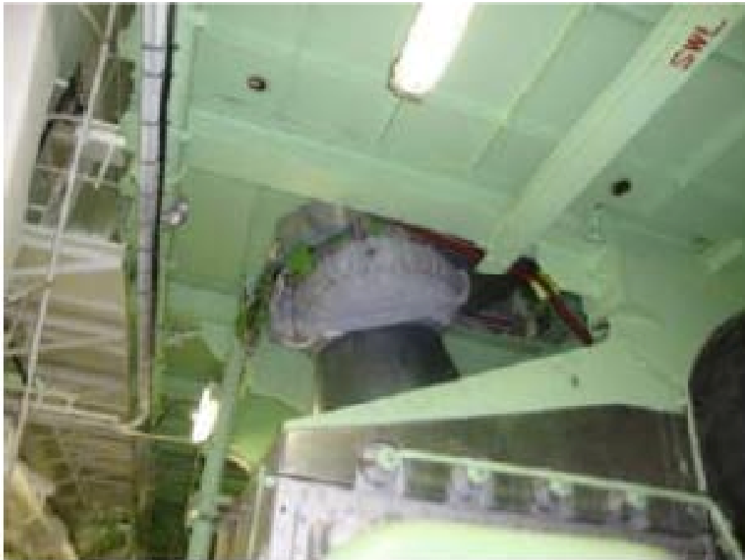
Εικόνα Νο.7 : Προσαρμογή βαλβίδας για την αποκοπή του υπερσυμπιεστή
