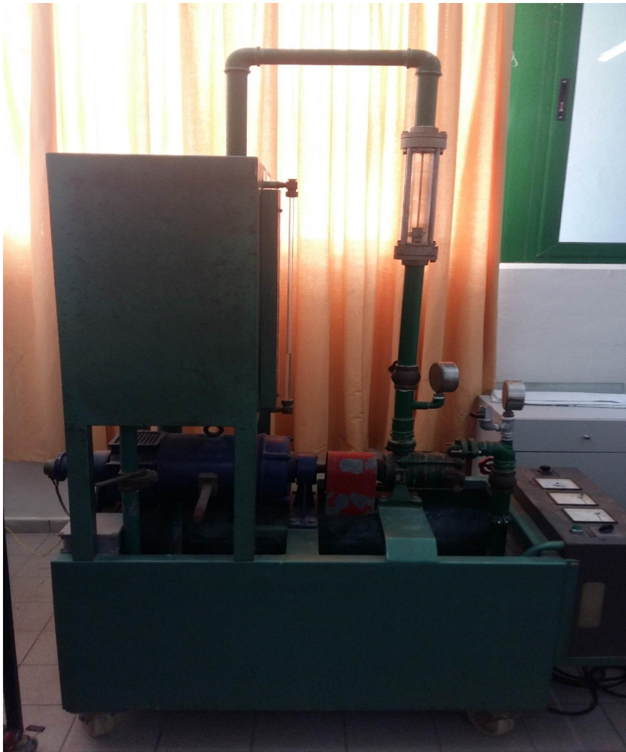
Εικόνα 2.1.3α: Σύστημα αντλία με δυο δεξαμενές
