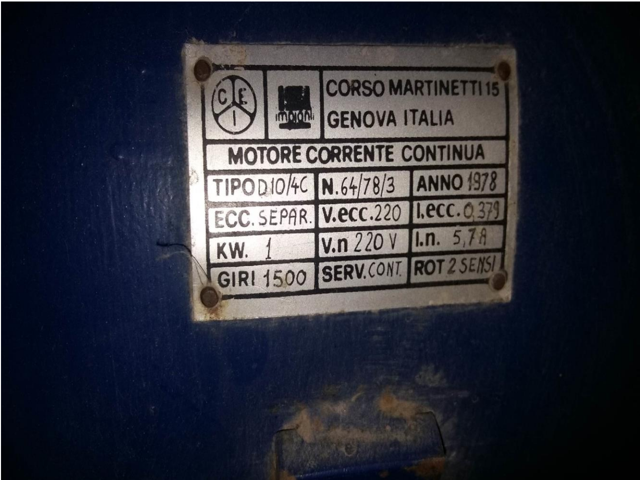
Εικόνα 2.1.2β: Στοιχεία κινητήρα
