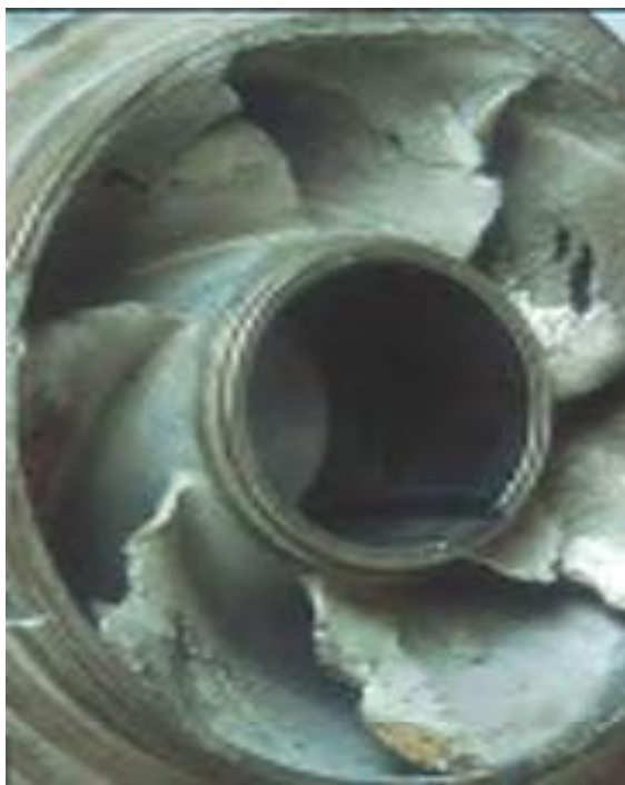
Εικόνα Νο.6 - Καταστροφή πτερυγίων σε στροφέιο φυγοκεντρικής αντλίας λόγω εμφάνισης του φαινομένου της υπερσπηλαιώσης.
