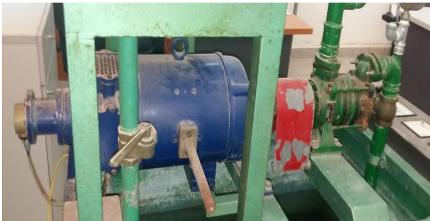
Εικόνα 4.1.β Κινητήρας και διβάθμια αντλία
