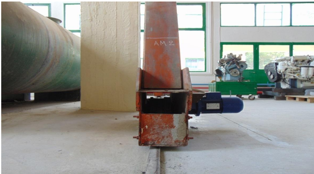
Εικόνα 28 Πρόοψη της αριστερής μπροστά πλευράς της γερανογέφυρας. Διακρίνεται ο ηλεκτροκινητήρας που είναι συνδεδεμένος με την κινήτρια τροχαλία, η μπούμα είναι συγκολλημένη ενώ η σύνδεση με τη βάση γίνεται με πείρο.
