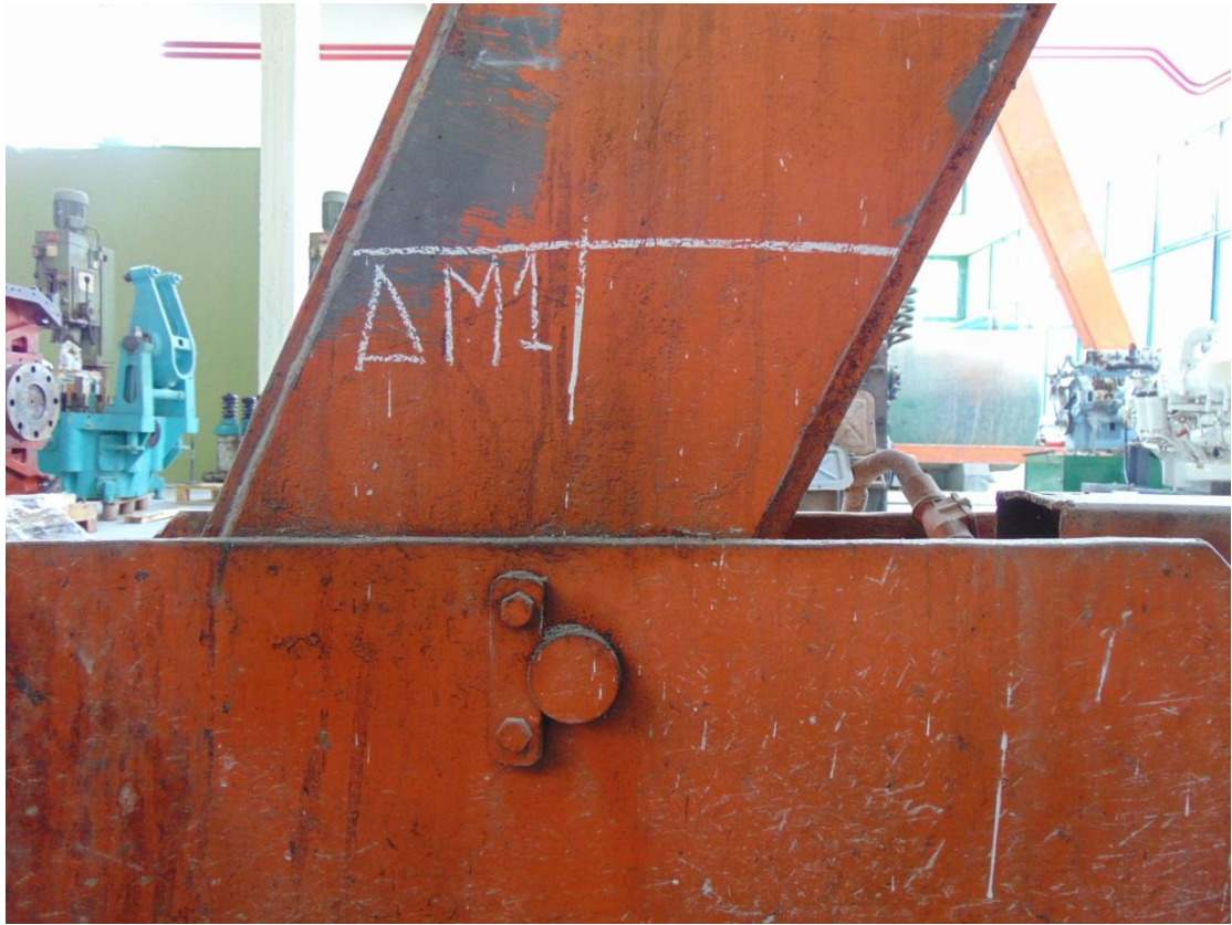
Εικόνα 37 Δεξιά πλάγια όψη της γερανογέφυρας. Διακρίνεται ο πείρος σύνδεσης της μπούμας με τη βάση.
