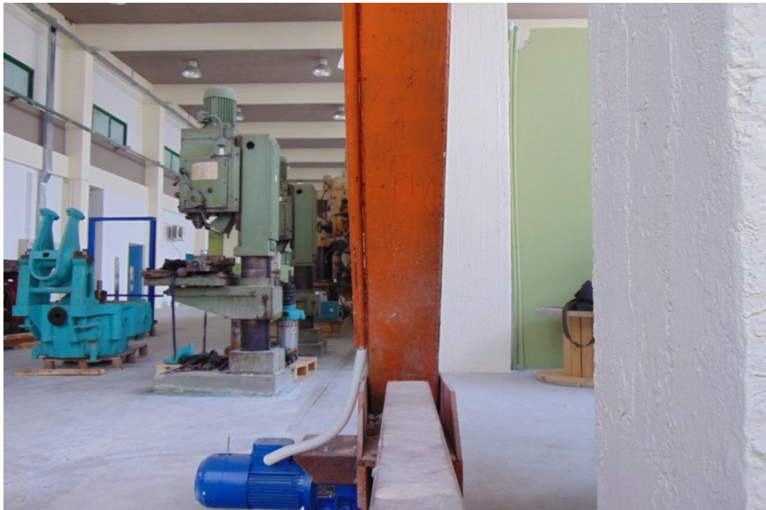
Εικόνα 31: Αποστατικός δοκός κάτω, στο αριστερό τμήμα της γερανογέφυρας. Φαίνεται το μειωμένο πάχος του σε σχέση με την μπούμα του κύριου κορμού. Διακρίνεται επίσης ο ηλεκτροκινητήρας και η καλωδίωσή του.
