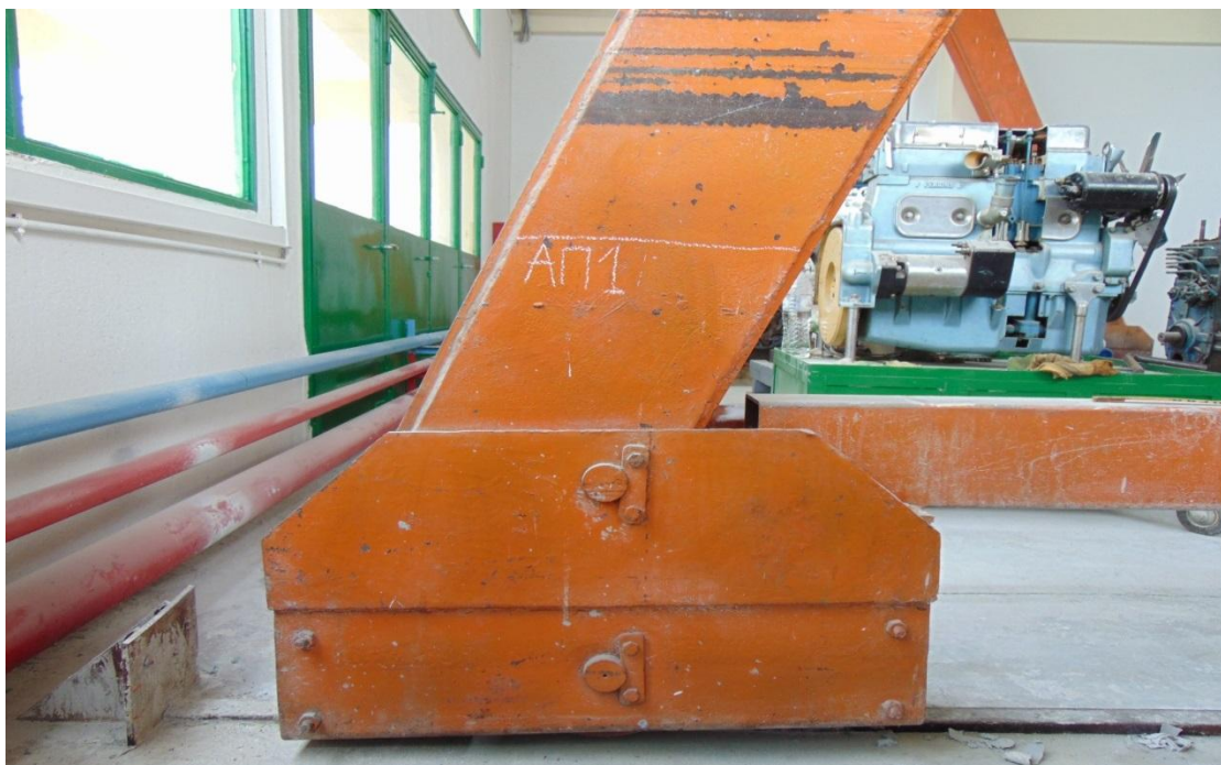
Εικόνα 32 Αριστερή πλάγια όψη του οπίσθιου μέρους της γερανογέφυρας. Διακρίνονται: ο πείρος του πίσω τροχού, ο πείρος σύνδεσης της μπούμας, το φρένο στο τέλος της σιδηροτροχιάς. Η βάση είναι λοξή λόγω υπερφόρτωσης ή κατασκευαστικού λάθους, ενώ οι εκδορές της μπούμας οφείλονται στην επαφή της με τον τοίχο του μηχανουργείου.
