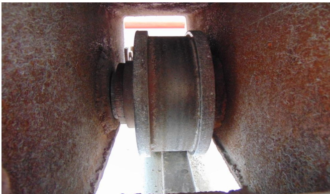
Εικόνα 35 Οπίσθιος βοηθητικός τροχός, χαρακτηριστικό του οποίου είναι ότι δεν έχει οδόντωση. Ο προορισμός του είναι να παραλαμβάνει το \frac{1}{4} του συνολικού βάρους της κατασκευής και του ωφέλιμου φορτίου που μπορεί να σηκώσει. Επίσης ο δεύτερος ρόλος του είναι να συγκρατεί σε σταθερή τροχιά την γερανογέφυρα.
