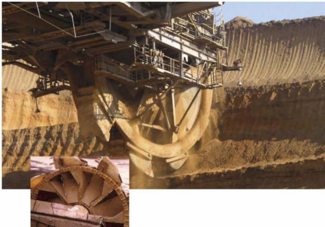
Σκαπτικό μηχάνημα εξόρυξης λυχνίτη με επιμεταλλωμένη επιφάνεια δράσης
