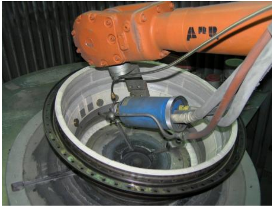
Ψεκασμός με χρήση πλάσματος σε εσωτερική επιφάνεια μετάλλου
