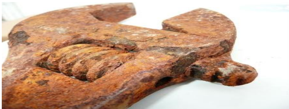
Απεικόνιση επίδρασης οξειδίων σε μέταλλο
