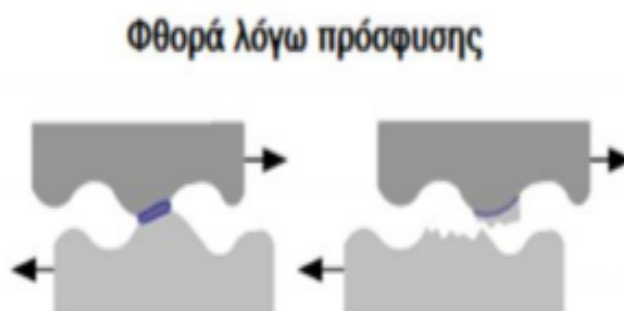
Εικόνα: Σχηματική παράσταση της φθοράς λόγω πρόσφυσης
