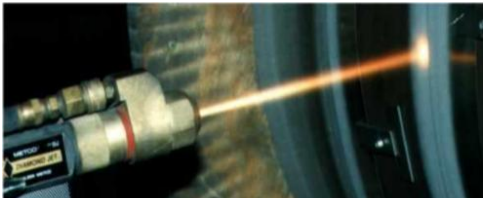
Προσομοίωση ψεκασμού υψηλής ταχύτητας με φλόγα καύσης
