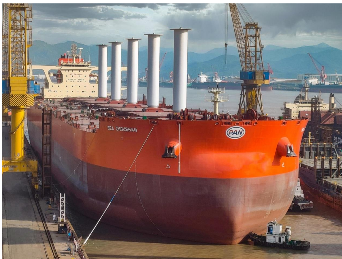
Εικόνα 12 Rotor Sails σε πλοίο τύπου VLOC της εταιρείας PAN
