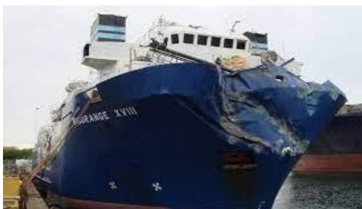
Εικόνα 3.2 Πλοίο που υπέστη σοβαρή ζημιά στη πλώρη.
