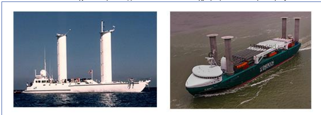
Εικόνα 3. Πλοία που χρησιμοποιούν ρότορες Flettner. Alcyone του Cousteau και δεξιά το E-Ship 1.
