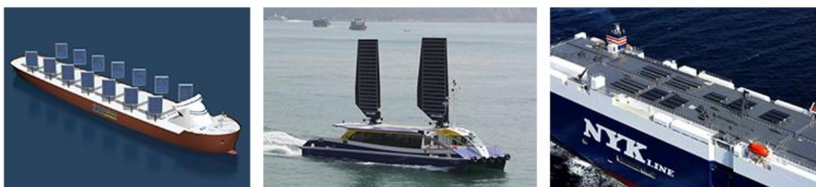
Εικόνα 5. Υβριδικά συστήματα με σταθερά πανιά και φωτοβολταϊκά. Από αριστερά προς τα δεξιά. 1) Aquarius MRE της Eco Marine Power, 2) Solar Sailor της OCIUS Technology, 3) Auriga Leader της NYK
