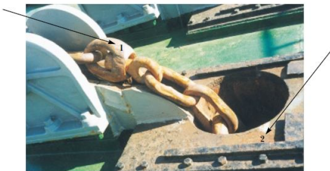
Εικόνα 4.4: 1. Στρεπτήρας άγκυρας, 2. Υποδοχές για τα συρταρωτά καλύμματα.
