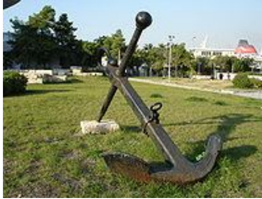
Εικόνα 3.12: Άγκυρα τύπου «Βρετανικού Ναυαρχείου».
