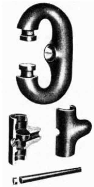
Σχήμα 4.3: Σχηματικά, τα μέρη από τα οποία αποτελείται το λυόμενο αγκύλιο της προηγούμενης εικόνας.
