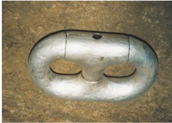
Εικόνα 4.10: Λυόμενο αγκύλιο (κλειδί) σύνδεσης αμμάτων τύπου “KENTER”.
