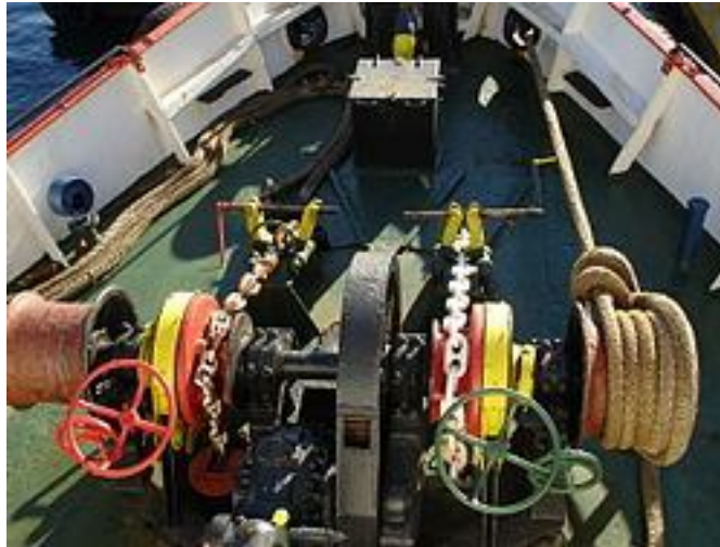
Εικόνα 4.7: Βαρούλκο αγκύρων ρυμουλκού.
