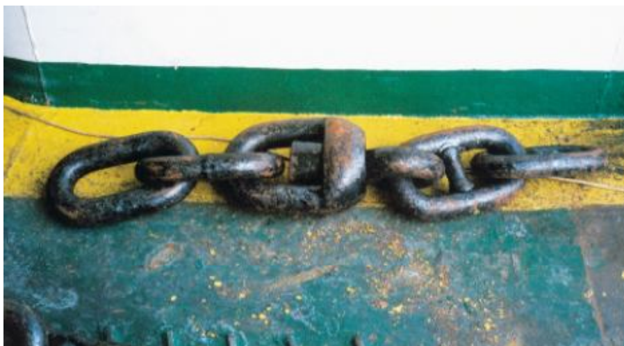
Εικόνα 4.3: Στρεπτήρας (στριφτάρι) σύνδεσης άγκυρας με την αλυσίδα (καδένα).
