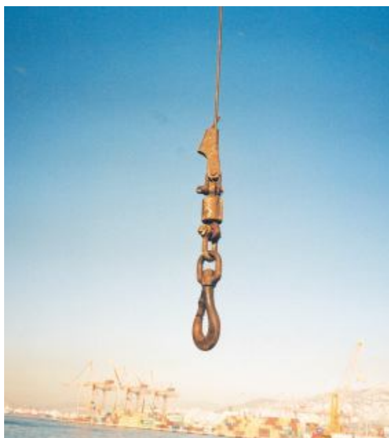
Εικόνα 4.5: Στρεπτήρας φορτωτήρων-γερανών. Στο άκρο του φέρει γάντζο για τη φορτοεκφόρτωση των φορτίων.
