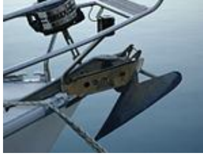
Εικόνα 3.13: Άγκυρα τύπου «αρότρου» μικρών ιστιοφόρων.
