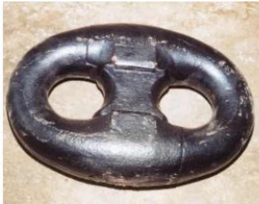
Εικόνα 4.9: Λύμενος τύπος κλειδιού αλυσίδας αγκυρών που χρησιμοποιείται στα σύγχρονα πλοία.
