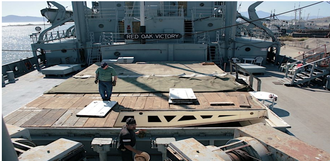
ΕΡΓΑΣΙΕΣ ΠΛΗΡΩΜΑΤΟΣ ΓΙΑ ΤΟ ΚΛΕΙΣΙΜΟ ΞΥΛΙΝΩΝ ΚΑΛΥΜΜΑΤΩΝ
