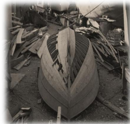
Εικόνα 59: Καΐκι κατασκευασμένο με τη Μέθοδο Μονοχναριού
