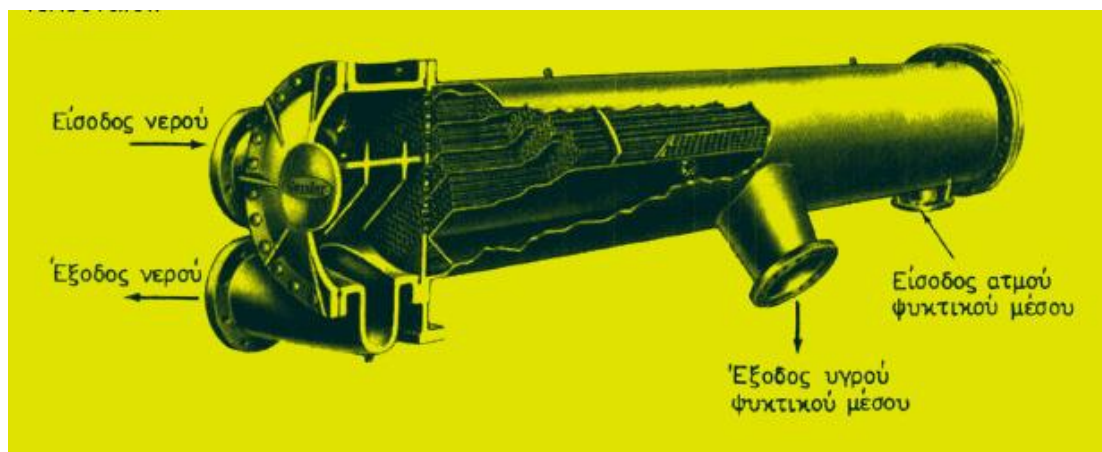
Εικόνα 11 Υδρόψυκτος συμπυκνωτής κελύφους - σωληνών
