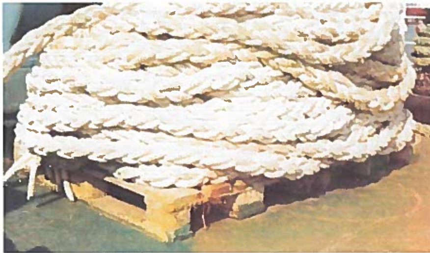
Εικόνα 5 Ντουκιάρισμα κάβου σε ξύλινο καφάσι
