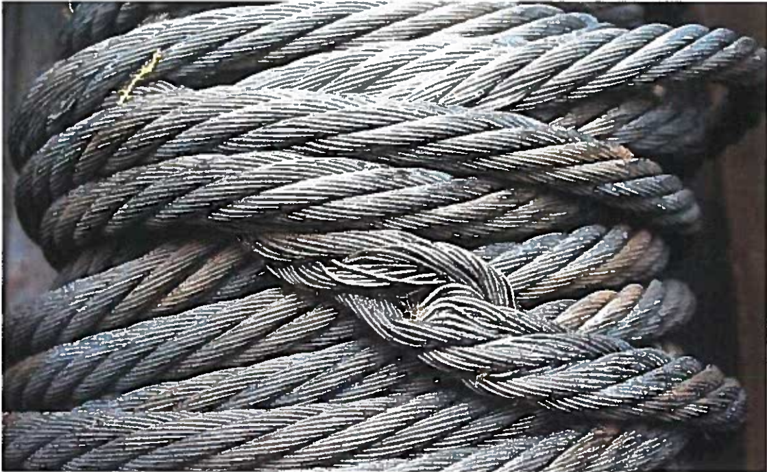
Εικόνα 11 Ζημιές στα συρματόσχοινα
