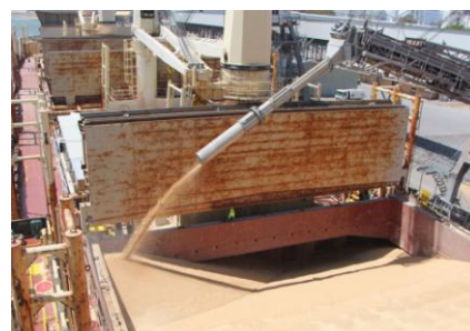
Σωλήνα αναρρόφησης στην φόρτωση
