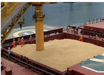
Σωλήνα αναρρόφησης στην εκφορτωση
