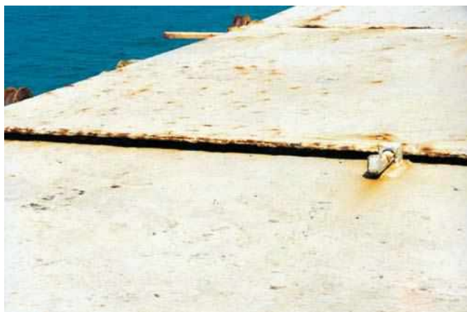
Εικόνα 37. Δύο panels εκτός ευθυγράμμισης (Πηγή: : https://www.standard-club.com/media/58123/MGHatchCoverMaintenance.pdf )
