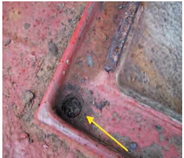
Εικόνα 16. Φράξιμο των καναλιών και τρυπών αποστραγγίσεως λόγω συγκέντρωσης διαφόρων καταλύπων και σκουριάς (Πηγή: https://www.ukpandi.com/news-and-resources/bulletins/2017/risk-focus-hatch-covers/ )
