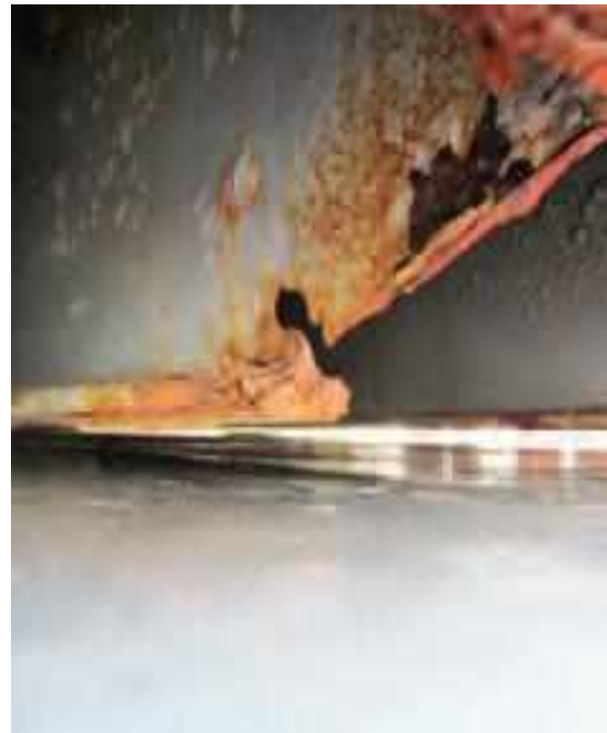
Εικόνα 21. Ρωγμές και διάβρωση που επηρεάζουν την κατασκευαστική δομή των panels (Πηγή: https://www.ukpandi.com/news-and-resources/bulletins/2017/risk-focus-hatch-covers/ )
