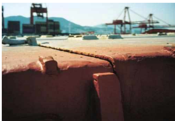
Εικόνα 36. Μη ευθυγραμμισμένα panel κατά το κλείσιμο (Πηγή: https://www.standard-club.com/media/58123/MGHatchCoverMaintenance.pdf )
