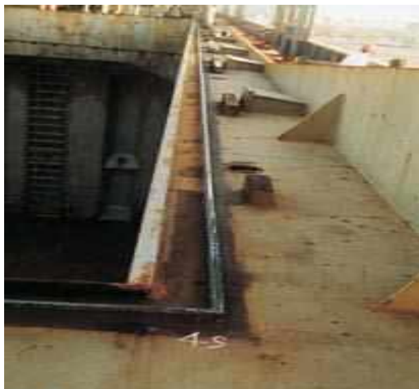
Εικόνα 29. Τυπικό σύστημα double drainage σε φορτηγό πλοίο (Πηγή: https://www.standard-club.com/media/58123/MGHatchCoverMaintenance.pdf )
