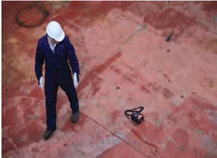
Εικόνα 34. Ultrasonic leak detection test-Τοποθέτηση μεταδότη στο αμπάρι (Πηγή: https://maritimecyprus.files.wordpress.com/2017/09/risk_focus_-_hatch_covers.pdf )
