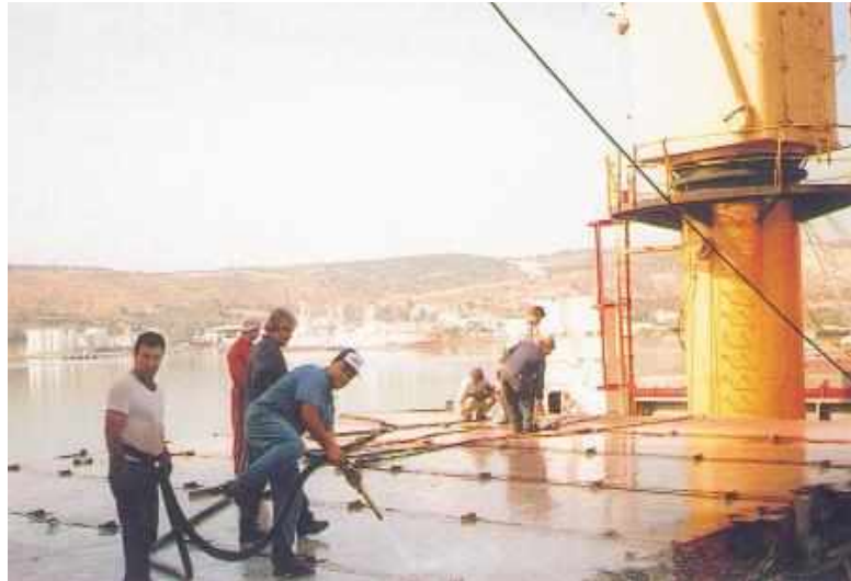
Εικόνα 32. Hose leak detection test (Πηγή: http://www.pi-schools.gr/lessons/tee/maritime/FILES/biblia/biblia/naytikh_texni_a/kef%2013.pdf )
