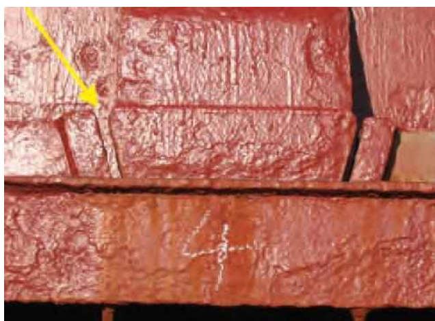
Εικόνα 14. Εμφανή ζημιά σε locator (Πηγή: https://www.ukpandi.com/news-and-resources/bulletins/2017/risk-focus-hatch-covers/ )
