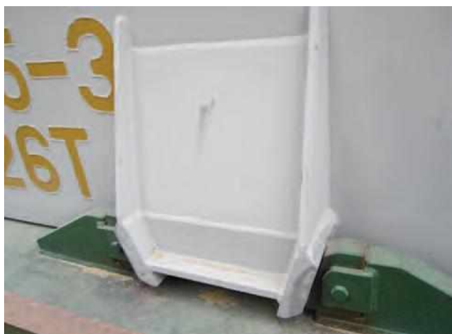
Εικόνα 13. Κατάλληλα συντηρημένος και τοποθετημένος locator (Πηγή: https://www.ukpandi.com/news-and-resources/bulletins/2017/risk-focus-hatch-covers/ )
