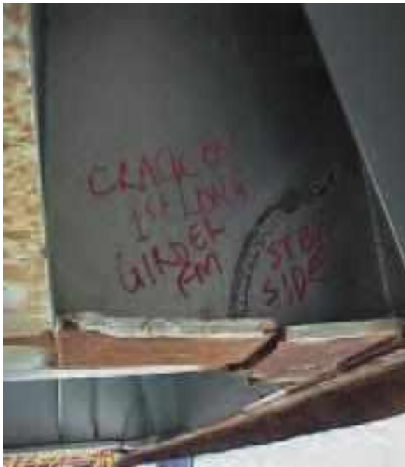
Εικόνα 21. Ρωγμές και διάβρωση που επηρεάζουν την κατασκευαστική δομή των panels (Πηγή: https://www.ukpandi.com/news-and-resources/bulletins/2017/risk-focus-hatch-covers/ )
