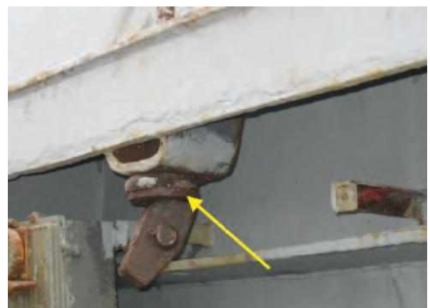
Εικόνα 18. Υπερβολική σύσφιξη του εξοπλισμού ασφαλίσεως από τα μέλη του πληρώματος με χρήση κλειδιού (Πηγή: https://www.ukpandi.com/news-and-resources/bulletins/2017/risk-focus-hatch-covers/ )
