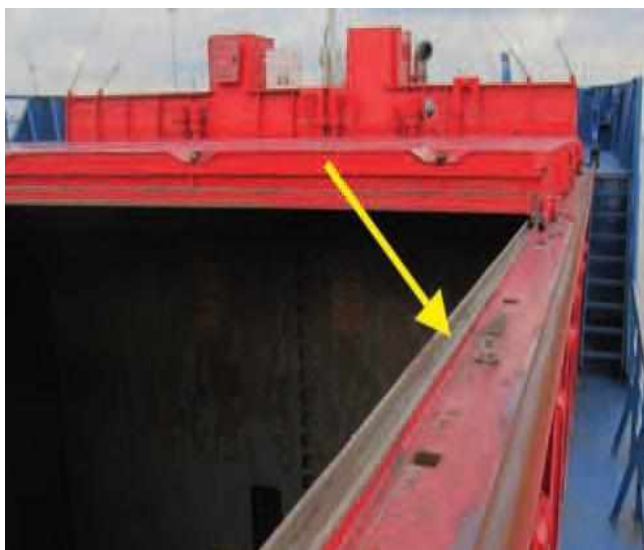
Εικόνα 19. Στρογγυλού και τετραγωνισμένου σχήματος compression bars (Πηγή: https://www.ukpandi.com/news-and-resources/bulletins/2017/risk-focus-hatch-covers/ )
