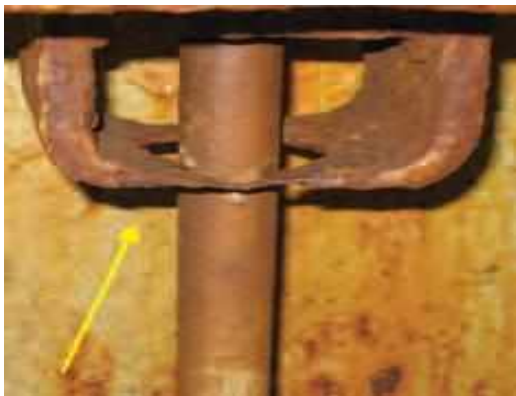
Εικόνα 17. Διάβρωση σε μηχανισμούς ασφαλίσεως των hatch covers (Πηγή: https://www.ukpandi.com/news-and-resources/bulletins/2017/risk-focus-hatch-covers/ )
