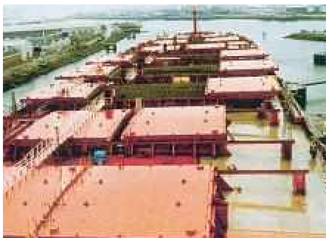
Εικόνα 8. Κυλιόμενα καλύμματα κλειστά σε πλοίο bulk carrier (Πηγή: http://www.pi-schools.gr/lessons/tee/maritime/FILES/biblia/biblia/naytikh_texni_a/kef%2013.pdf )
