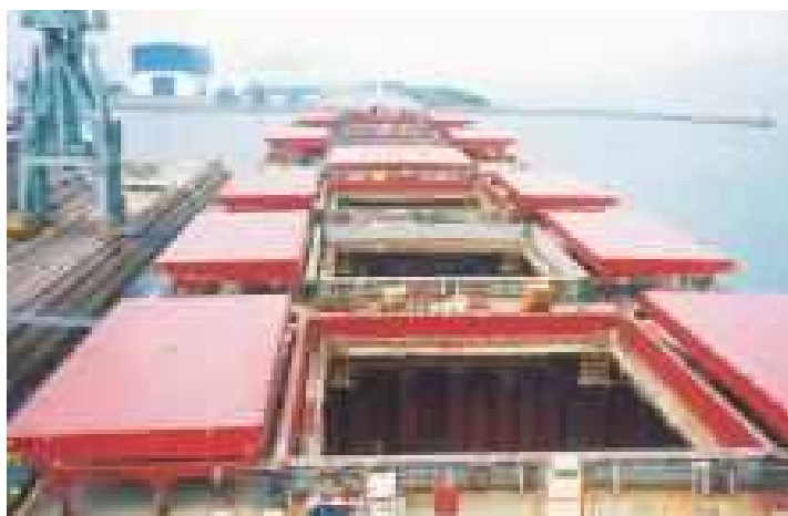
Εικόνα 7. Κυλιόμενα καλύμματα ανοιχτά σε πλοίο bulk carrier (Πηγή: http://www.pi-schools.gr/lessons/tee/maritime/FILES/biblia/biblia/naytikh_texni_a/kef%2013.pdf )
