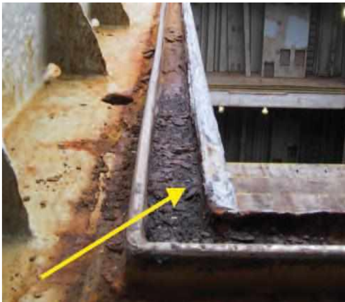
Εικόνα 16. Φράξιμο των καναλιών και τρυπών αποστραγγίσεως λόγω συγκέντρωσης διαφόρων καταλύπων και σκουριάς (Πηγή: https://www.ukpandi.com/news-and-resources/bulletins/2017/risk-focus-hatch-covers/ )
