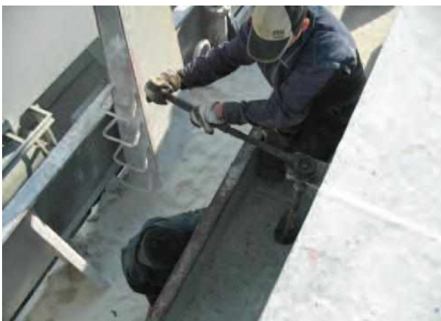
Εικόνα 18. Υπερβολική σύσφιξη του εξοπλισμού ασφαλίσεως από τα μέλη του πληρώματος με χρήση κλειδιού (Πηγή: https://www.ukpandi.com/news-and-resources/bulletins/2017/risk-focus-hatch-covers/ )
