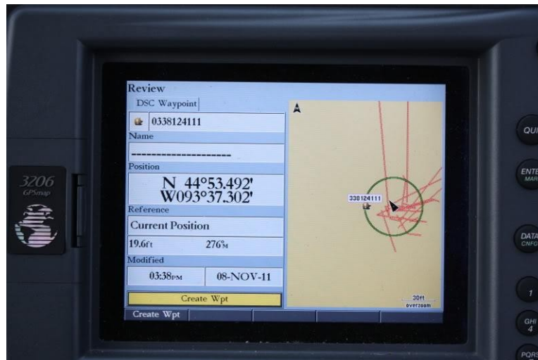
Οθόνη ενός ραντάρ που μας δείχνει στοιχεία του σκάφους όπως τον μοναδικό αριθμό MMSI και τις συντεταγμένες του
