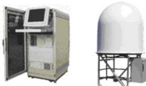
Εικόνα 9: Σταθμό Λήψεως Εδάφους LEOLUT - GEOLUT
