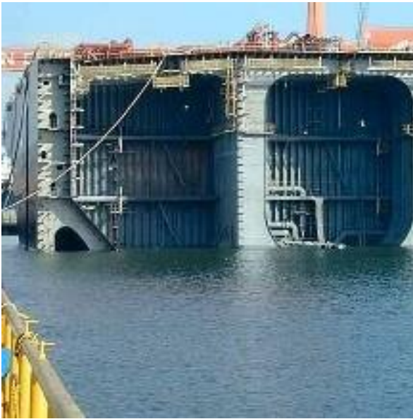
Διάφραγμα και διπύθμενο ενός Δ/Ξ
