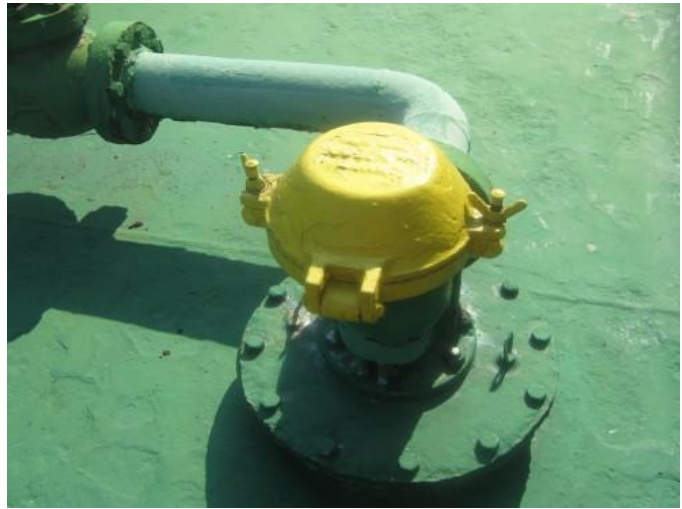
COW machine στο κατάστρωμα του πλοίου
