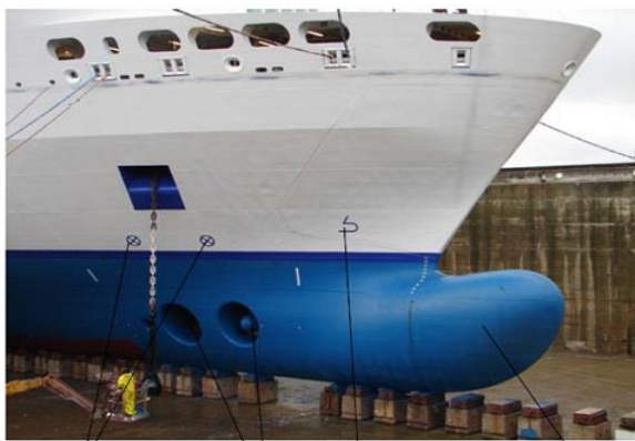
Τα σχήματα αυτά δείχνουν την παρουσία έλικας πλώρης. Ελικες πλώρης. Το σχήμα αυτό δείχνει την παρουσία του βολβού.
