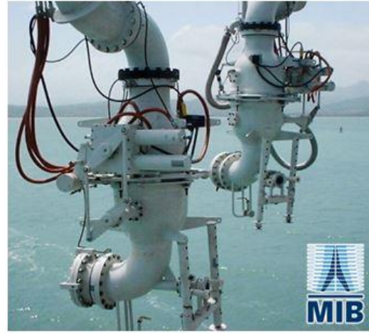
Αριστερά κλείδωμα το σύστημα QC/DC ενώ δεξιά ο μηχανισμός PERC
