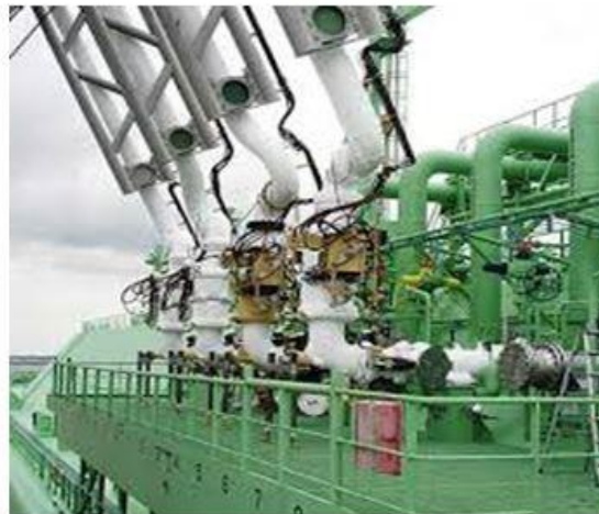
Βραχίονες φορτοεκφόρτωσης συνδεδεμένοι με τις πολλαπλές του πλοίου
