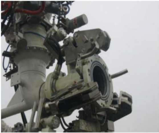
Αριστερά κλείδωμα το σύστημα QC/DC ενώ δεξιά ο μηχανισμός PERC
