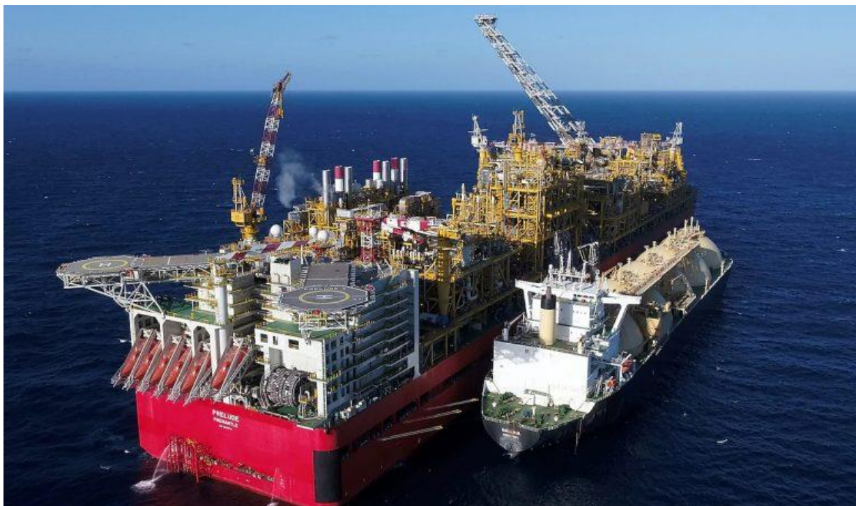
Η πλωτή εγκατάσταση Prelude κατά την διάρκεια φόρτωσης σε συμβατικό πλοίο μεταφοράς ΥΦΑ
