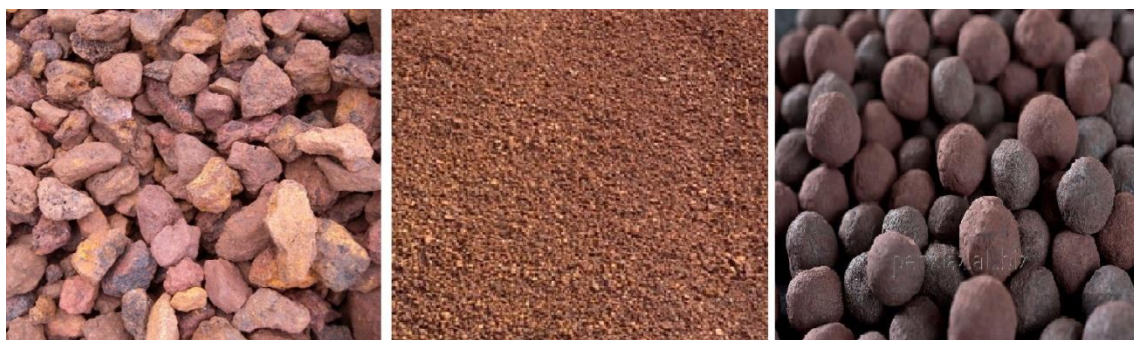
ΕΙΚΟΝΑ 1.2.2: Αριστερή εικόνα: Χονδρόκοκκο μετάλλευμα, Μεσαία εικόνα: Λεπτόκοκκο μετάλλευμα, Δεξιά εικόνα: Σφαιρίδια μεταλλεύματος
