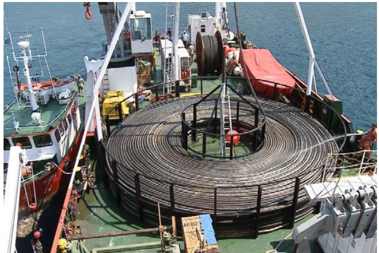
Εικόνα 4.6.1.2 χώρος αποθήκευσης του καλωδίου
