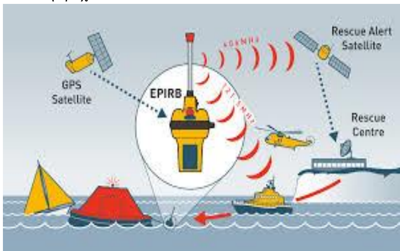
Εικόνα 2.12.β: Λειτουργία συστήματος EPIRB
