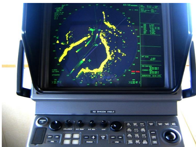
Εικόνα 1.2.7α : Ραντάρ με ενσωματωμένο σύστημα ARPA
