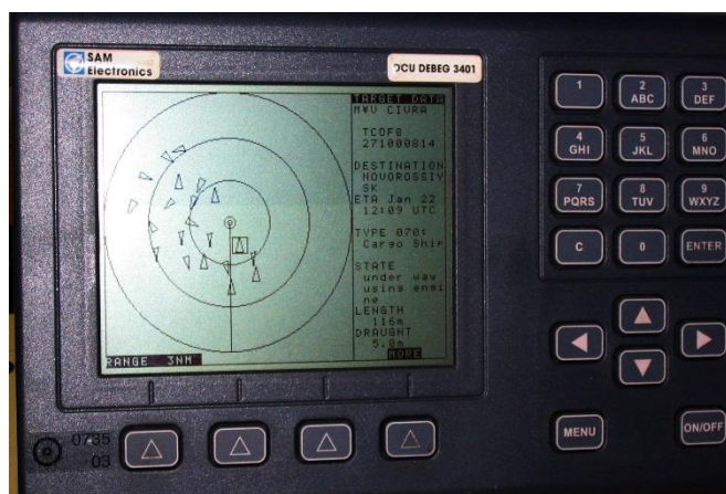
Εικόνα 1.6.1α : AIS (Automatic Identification System)
