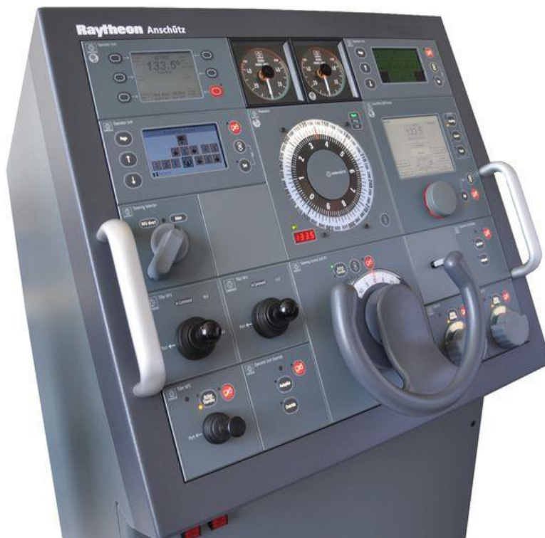
Εικόνα 1.9.2: Ολοκληρωμένο σύστημα πηδαλιουχίσεως εμπορικού πλοίου
