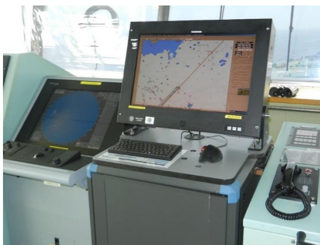
Εικόνα 1.3.2 : ECDIS (Electronic Charts and Display Information System)
