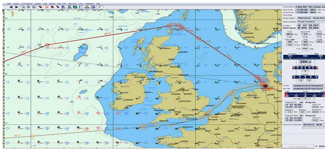
Εικόνα 1.3.5α : Σχεδιασμένη πορεία πάνω σε ηλεκτρονικό χάρτη στο σύστημα ECDIS
