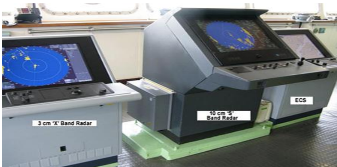
Εικόνα 1.2.3 : Συσκευές Radar 3 cm και 10 cm
