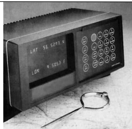
(β) Νεότερος δέκτης συστήματος DECCA, με ψηφιακή οθόνη ενδείξεως γεωγραφικών συντεταγμένων.
