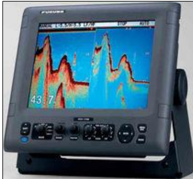
Σχ. 5.1π. Ενδείξεις του σύγχρονου βυθόμετρου σε οθόνη υγρών κρυστάλλων.
