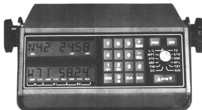
(δ) Νεότερος δέκτης LORAN, με ψηφιακή οθόνη ενδείξεως γεωγραφικών συντεταγμένων.
