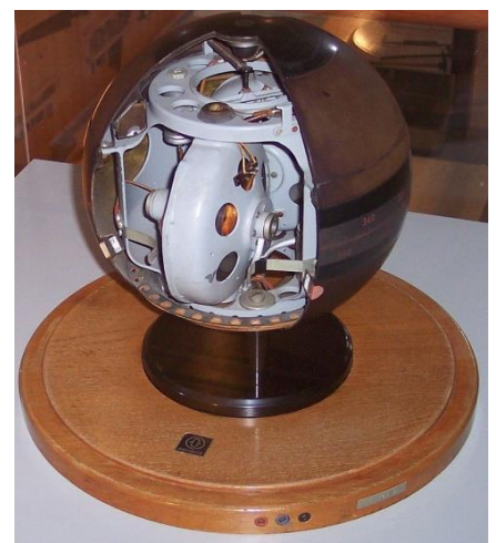
Σχ. 2.1ζ. Η πρώτη γυροπυξίδα του γερμανού Anschütz, 1903
