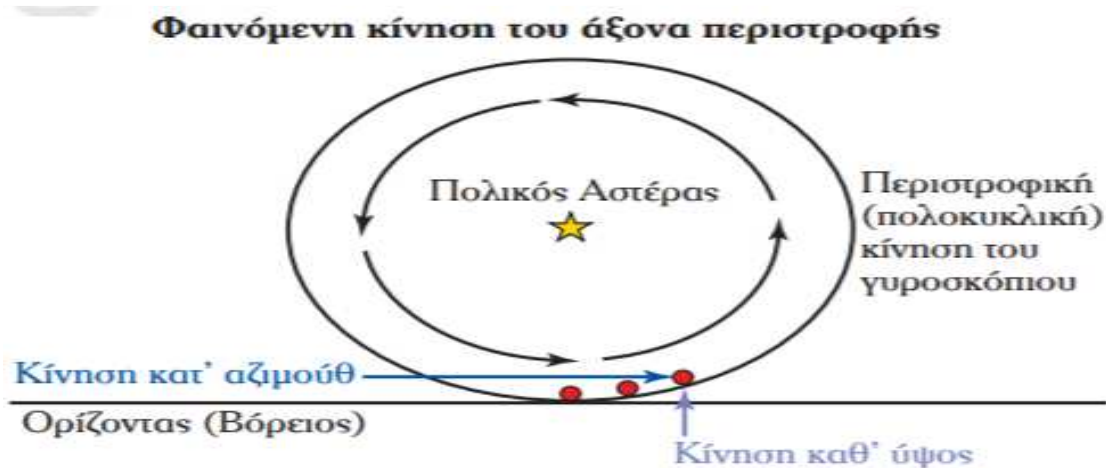
Εικόνα 26 Οι (διανυσματικές) συνιστώσες της κινήσεως στο ελεύθερο γυροσκόπιο.
