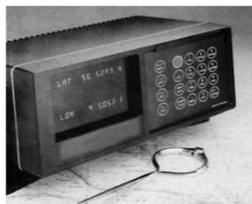
(β) Νεότερος δέκτης συστήματος DECCA, με ψηφιακή οθόνη ενδείξεως γεωγραφικών συντεταγμένων.
