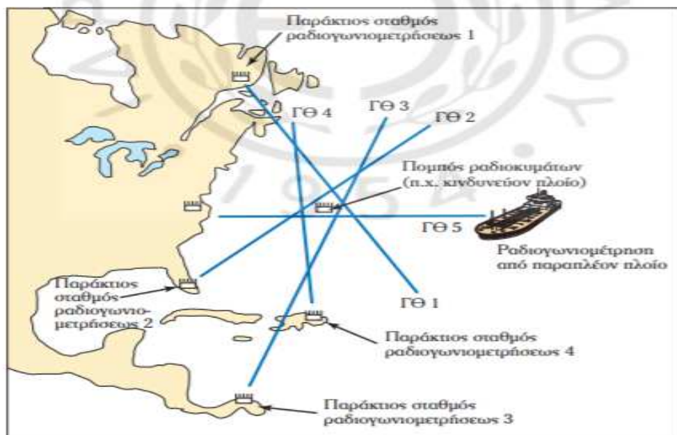
Εικόνα 7 Ραδιοεντοπισμός κινδυνεύοντος πλοίου με ραδιοδιοπευσεις από παράκτιους σταθμούς και παραπλέον πλοίο.
